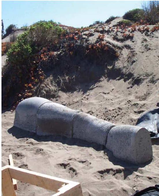
Moldajes flexibles, horizontales y verticales una vez desmoldados conservan la esbeltez de las telas.
