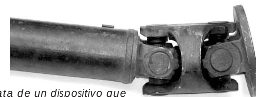
Invencción de Cardano, que trata de un dispositivo que permite conservar la horizontalidad mediante dos ejes que giran en ángulo.
