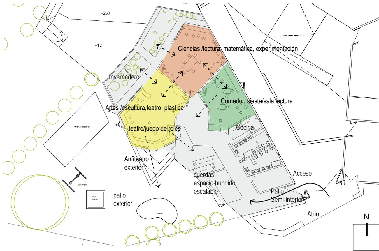
esquema dinamismo, se produce una tensión entre interior y exterior, quedando un espesor de exterior que es aula. Conformando un vínculo con el territorio extenso
