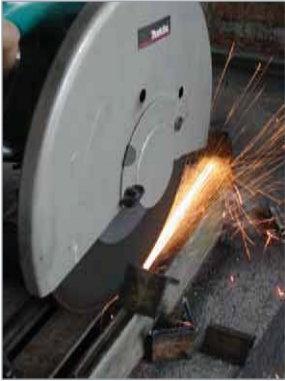
Corte de perfil L, Taller de Obra, 2006.
