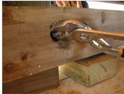
sostener hilo metalico para desatornillar tuercas
