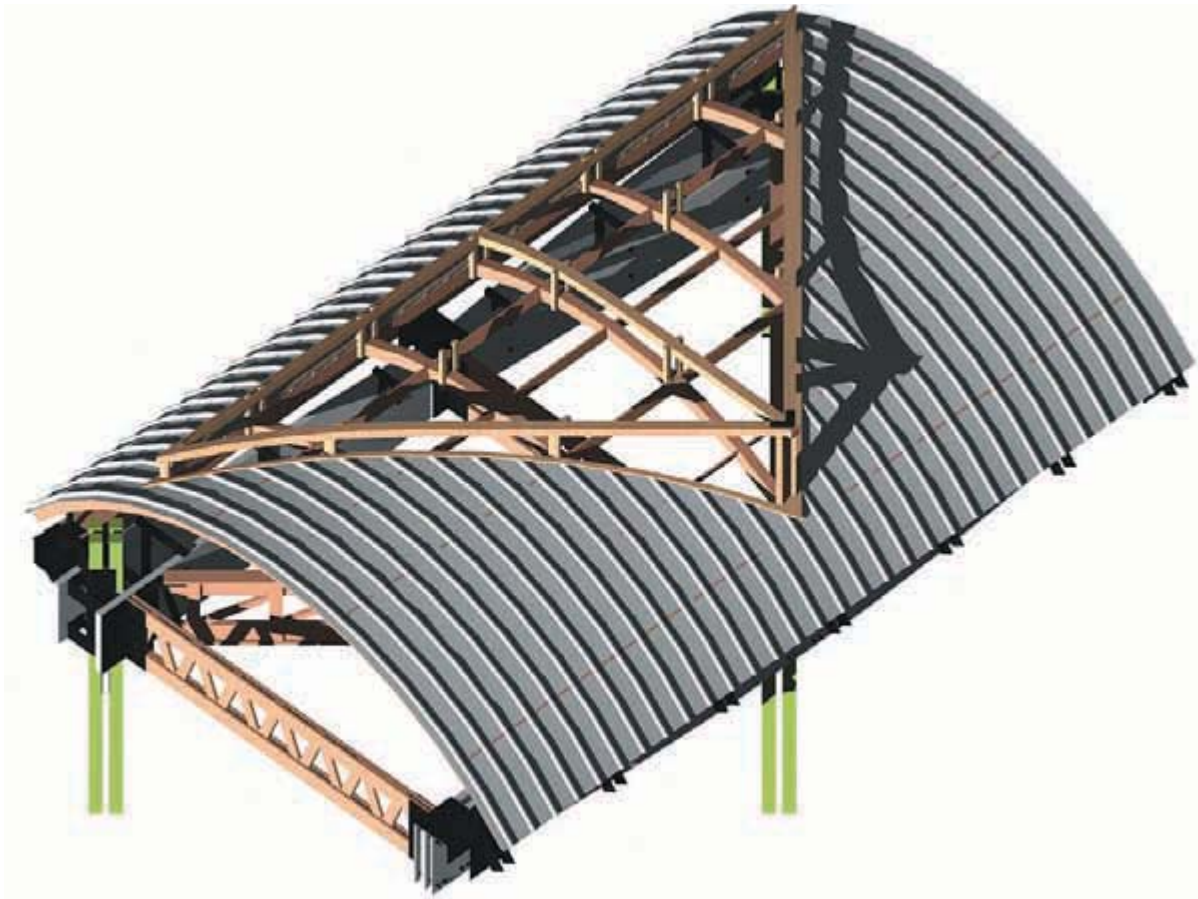
PASO 3/ Luego de emplazar todos los pies derechos se apoyan las vigas principales de la cubierta.
