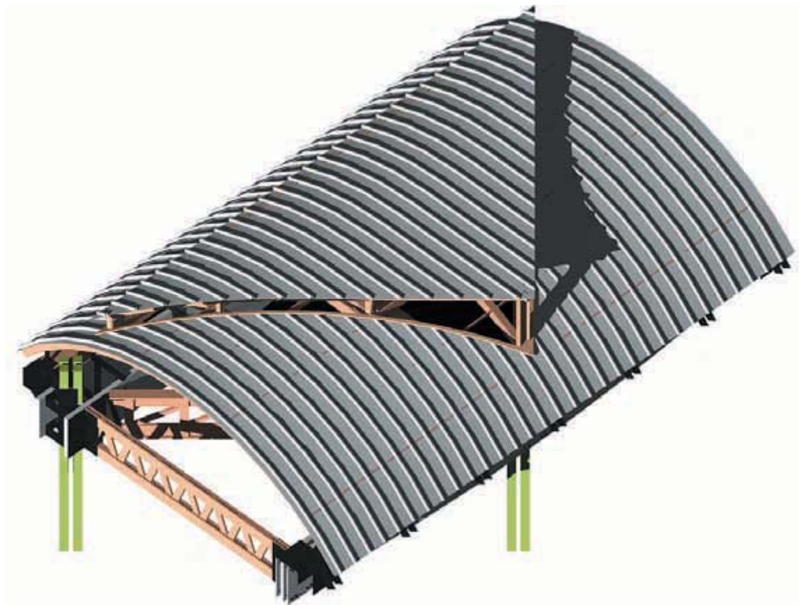
PASO 6/ Finalmente se instala la cubierta Hunter-Douglas de la lucarna.
