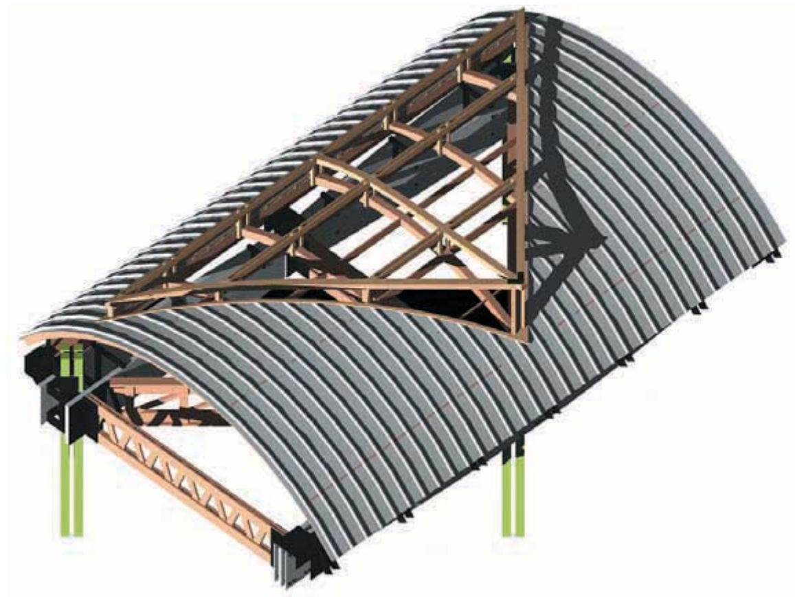
PASO 5/ Se adosan los ventanales de policarbonato alveolar.
