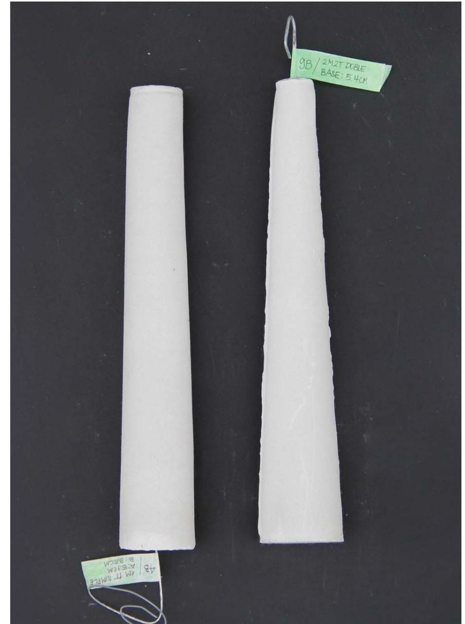
Foto: Mejores modelos ejecutados de columnas cónicas.
