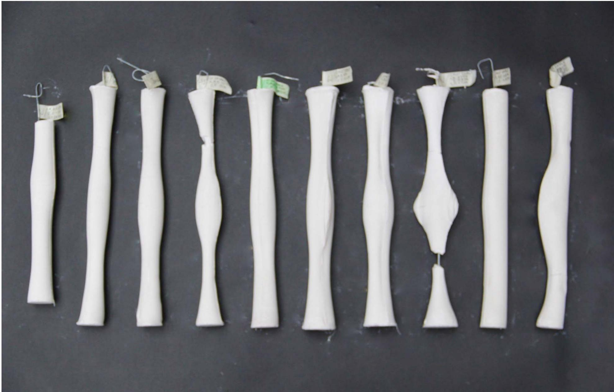
Foto: Columnas angostada doble ordenadas según la tabla de registro.
