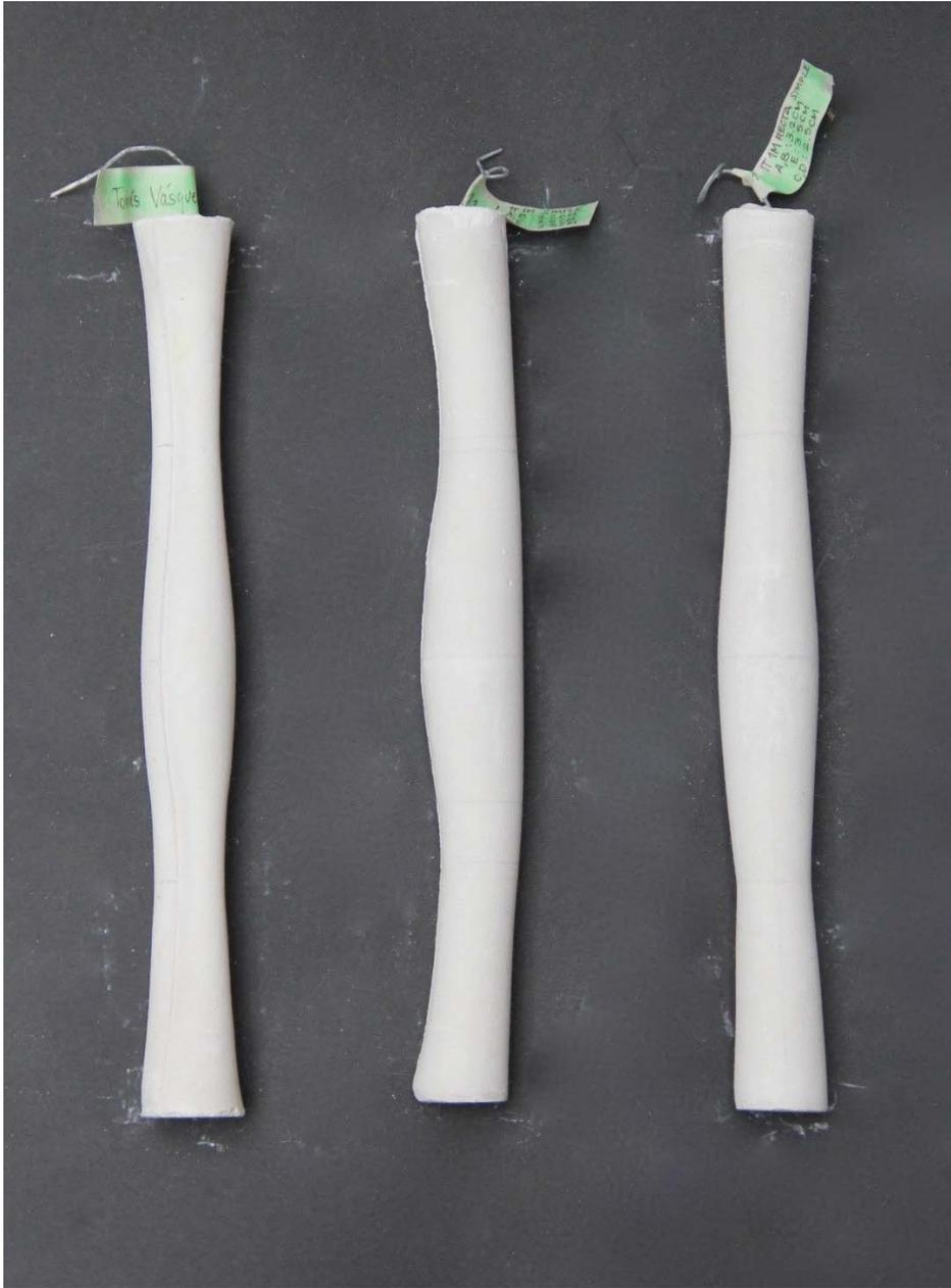
Foto: Mejores modelos ejecutados de columnas angostadas doble.
