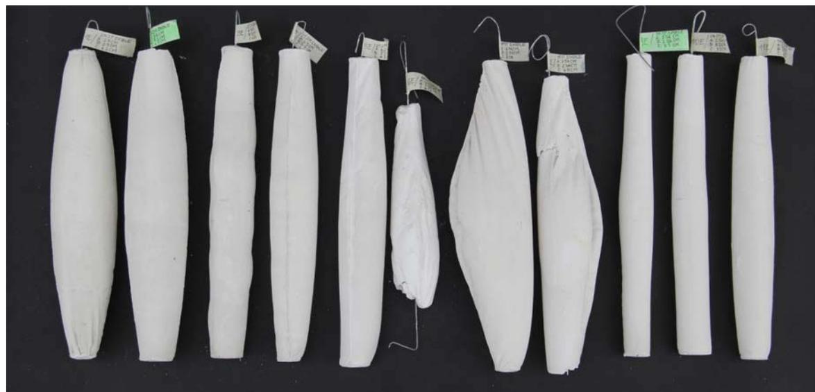
Foto: Columnas abultadas (pruebas) ordenadas según la tabla de registro.
