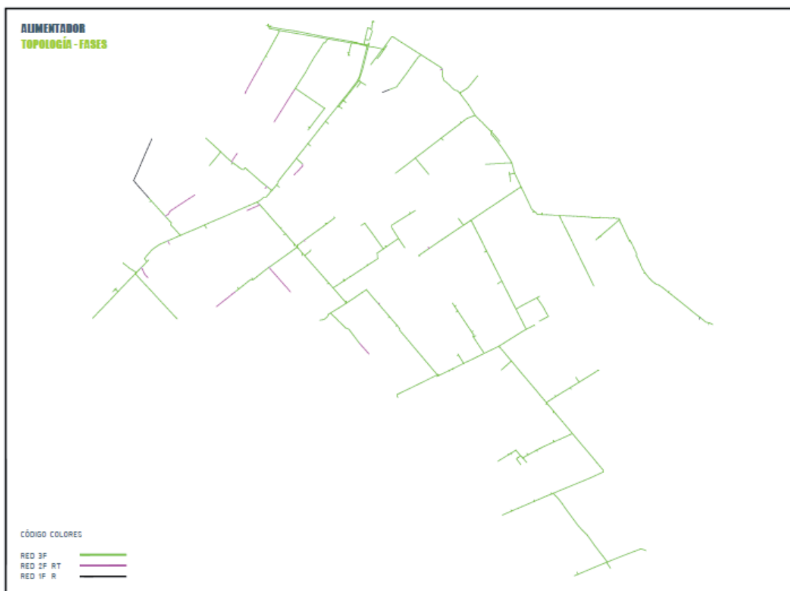
Figura 5-2 Topología Fases del Alimentador (Fuente: Elaboración propia)
