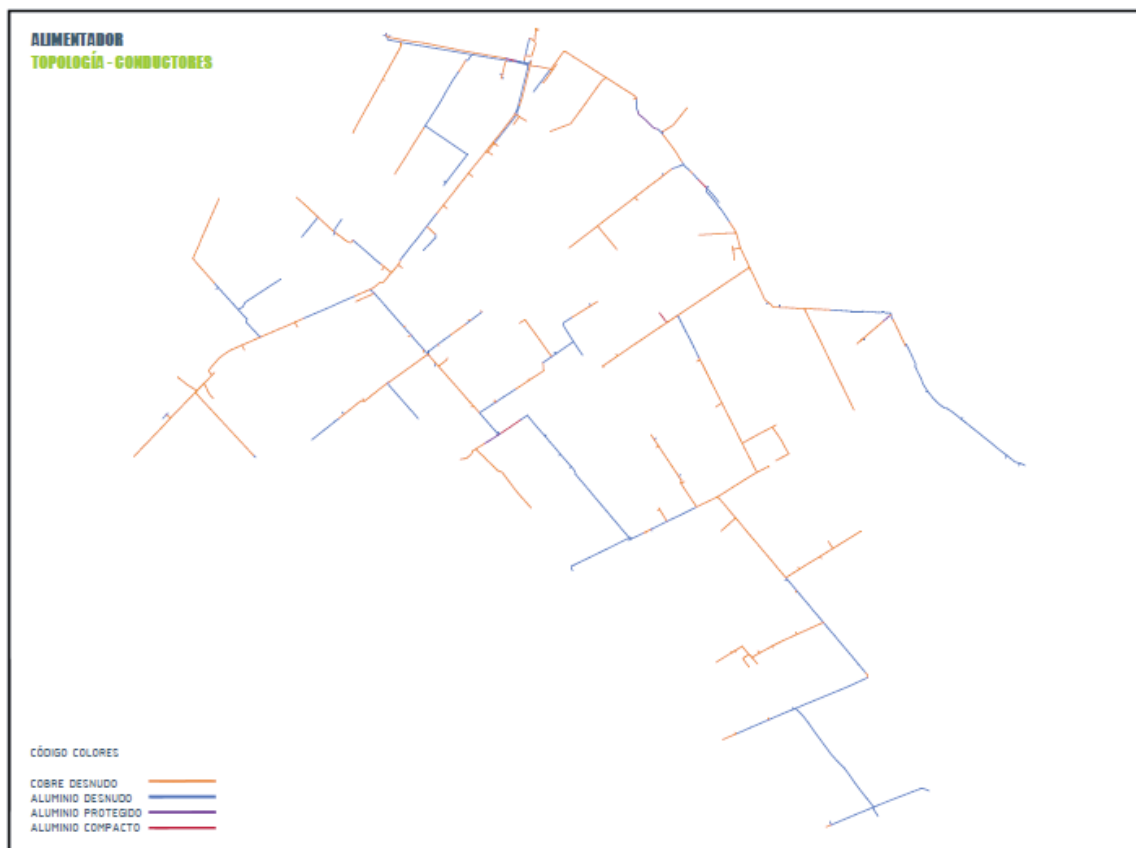
Figura 5-3 Topología Conductores del Alimentador (Fuente: Elaboración propia)
