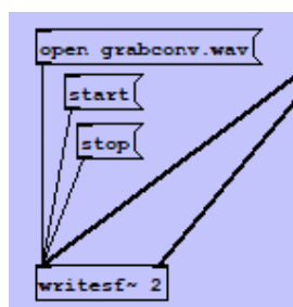
Figura 4-8: Programa con el objeto “writesf~” agregado para grabar la señal resultante en formato WAV.
