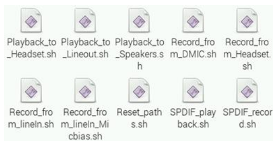
Figura A-7: Scripts de configuración de las entradas y salidas de la tarjeta Cirrus Logic
