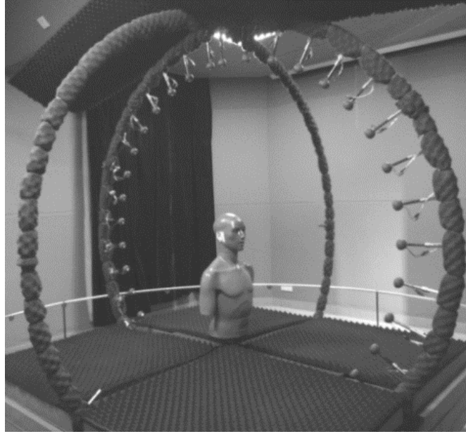
Figura 2-11: Maniquí KEMAR con el cual se realizaron las mediciones de las HRTF [8].
