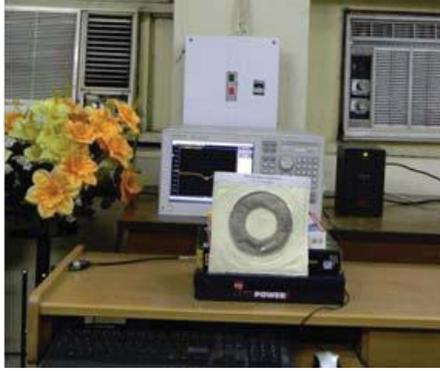
Figura 1-27: Antena *Microstrip* anillo anular Prototipo [28].
