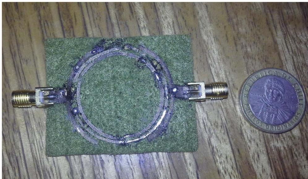
Figura 3-7: Efecto de soldadura en textil conductor.
