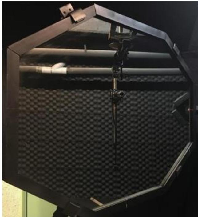
Figura 2-15 Espejo del Goniómetro de Espejo.
