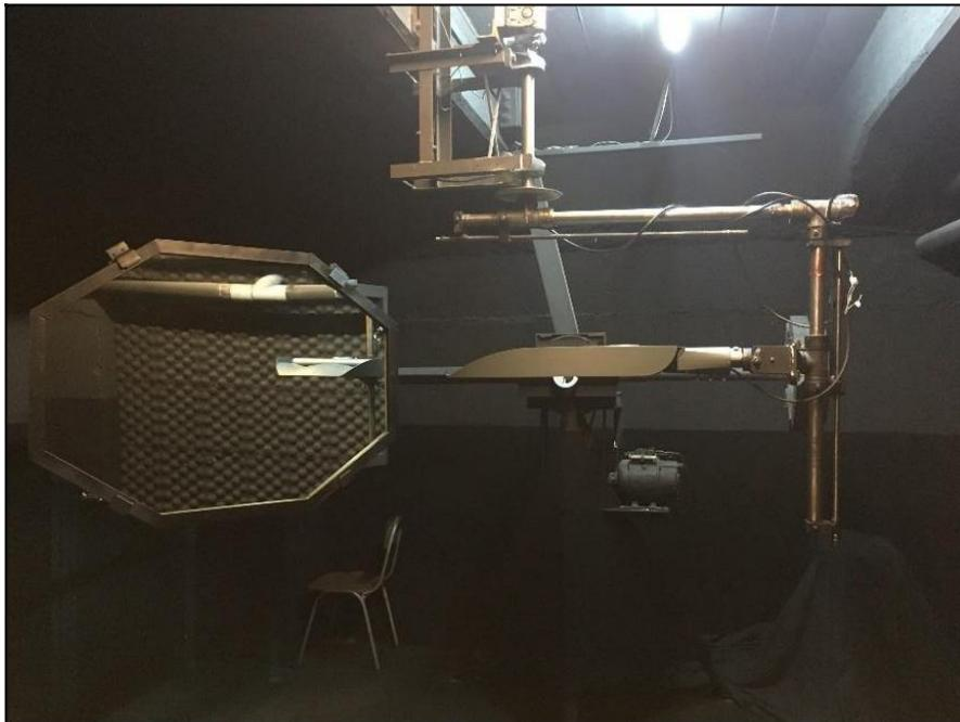
Figura 1-9 Goniómetro de Espejo con el montaje de una luminaria de alumbrado público.
