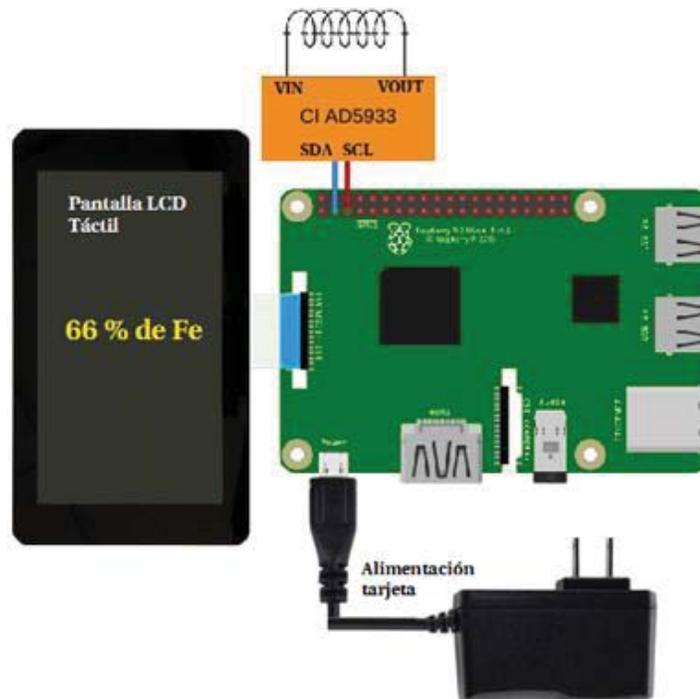
Figura 3-12. Diagrama general de conexión física del sistema completo.
