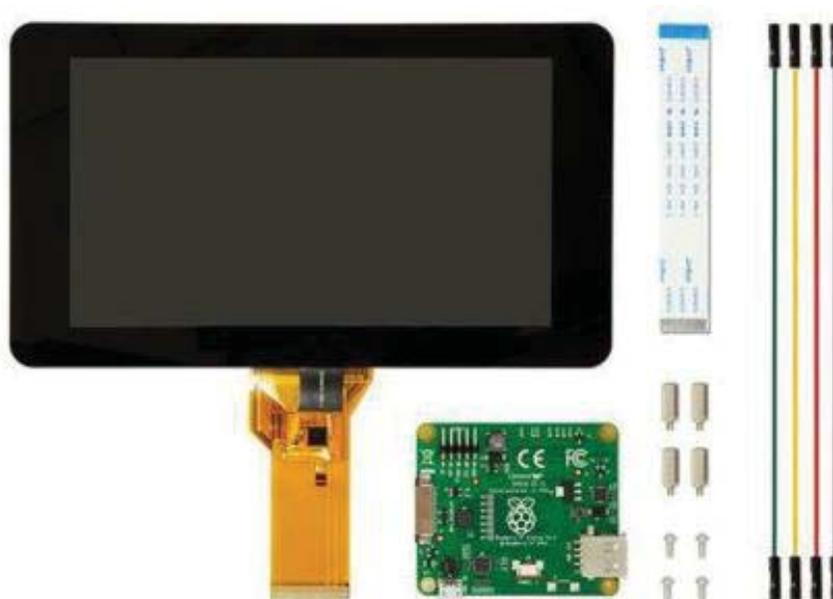
Figura 3-9. Componentes de la pantalla LCD oficial, (fuente: rcomponents.com).
