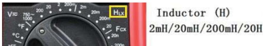
Figura 2-2 Multímetro UNI-T UT70A, con sus rangos de inductancias a medir (Fuente: dx.com).
