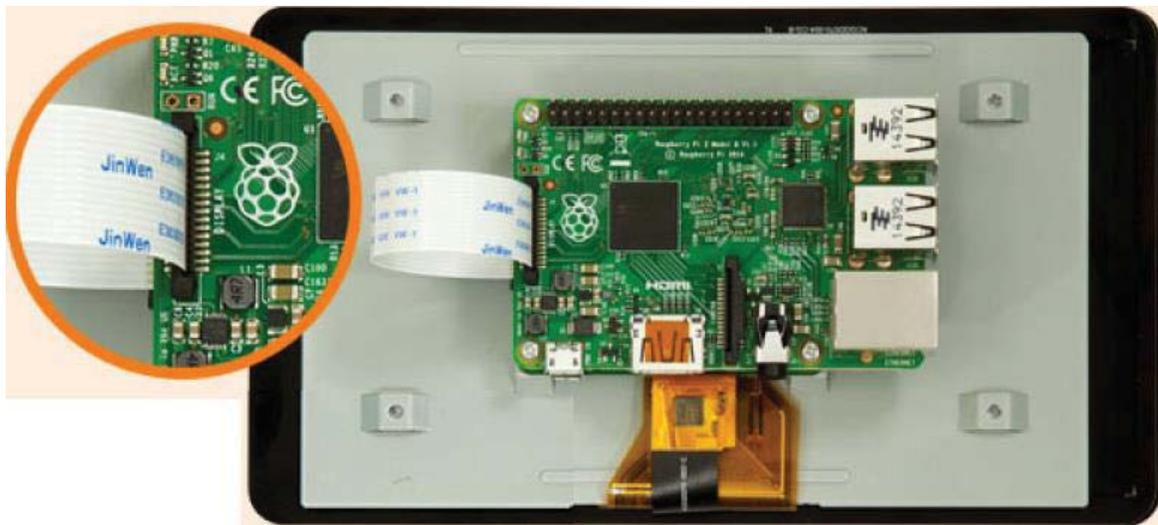
Figura 3-10. Raspberry Pi 3 conectado a una pantalla táctil de 7 pulgadas (Fuente: <http://docs-europe.electrocomponents.com>)
