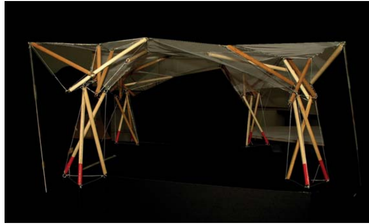
Img.7 | Maqueta estructural
