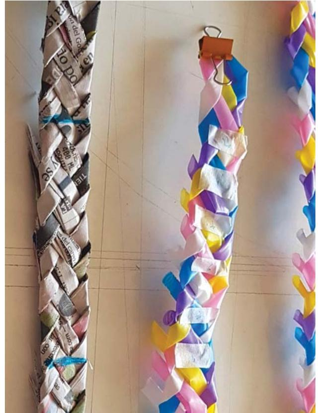
*Imagen 52 (arriba): Se muestra los tipos de materiales utilizados para hacer las trenzas en el experimento, además de usar una trenza de trigo, se fabricaron trenzas de plástico y diario, tratando de encontrar un material con resistencia parecida al trigo, pudiendo así probar la resistencia del trenzado. Fotografía tomada por autoras.*
