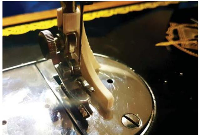
*Imagen 65: Modificación de la Máquina pieza 2. Fotografías sacadas por las autoras.*
