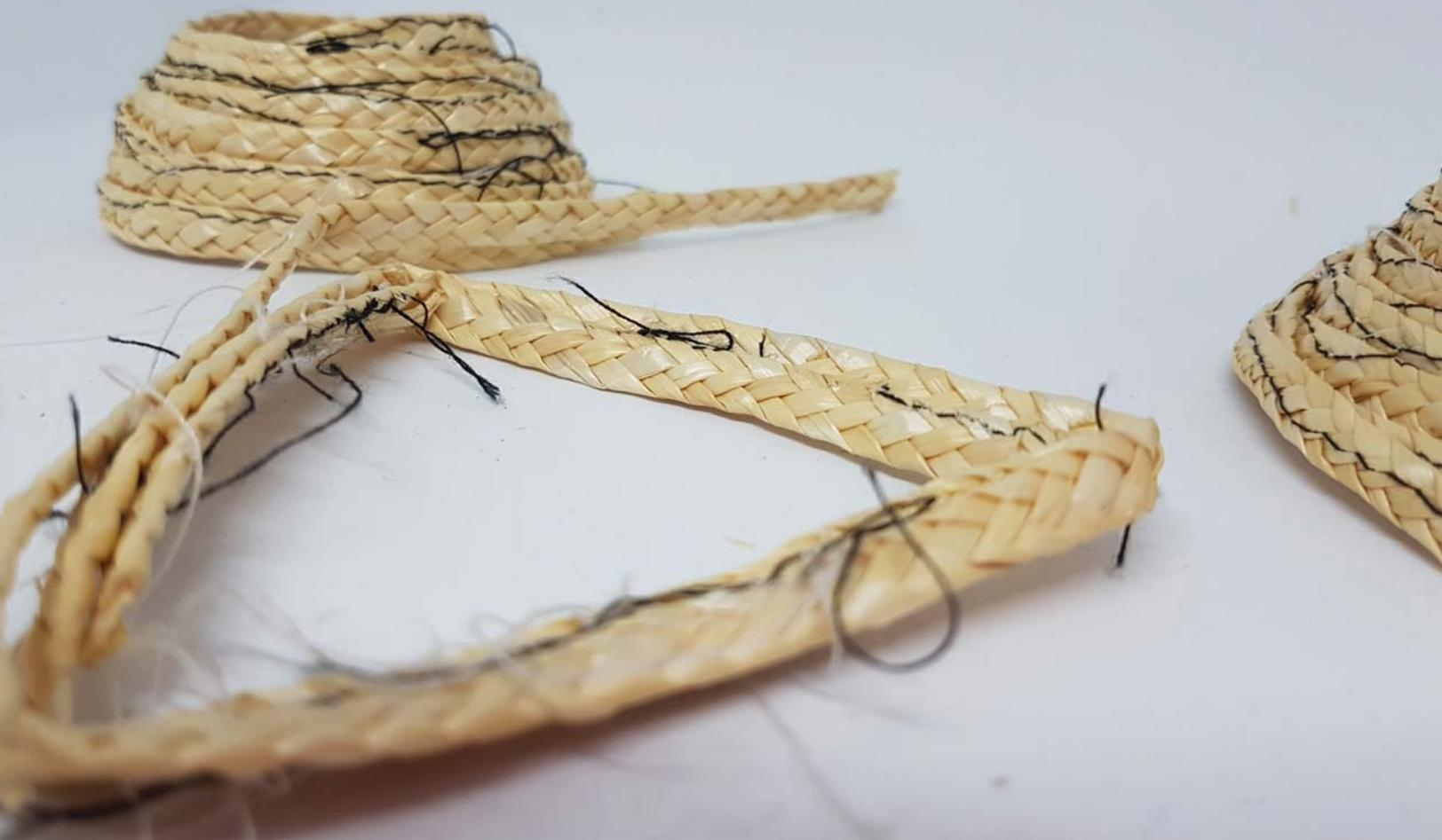
*Imagen 61 (arriba): La segunda prueba de costureado consiste en realizar un triángulo con quiebres, el resultado de éste mostró una incapacidad de la máquina para costurar esos puntos de quiebre. (abajo) Se denota la desprolijidad del costureado que se tuvo en el principio de las pruebas con la máquina de coser, se logra en ese punto generar una superficie, pero no con la pulcritud de la chupalla. Fotografías sacadas por las autoras.*
