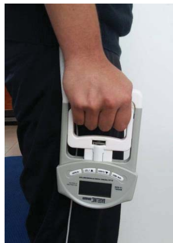
Figura 9. Medición de presión manual
