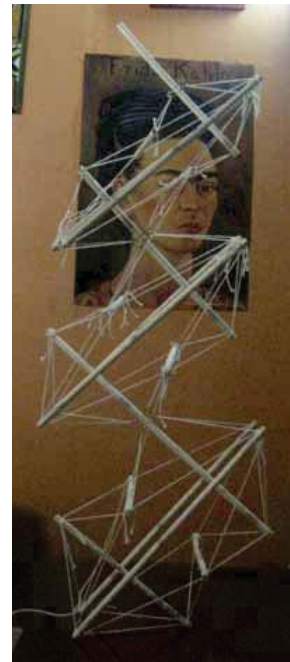
Columna en base de unidades icosaedro (modelo original).
