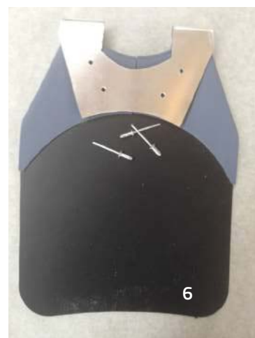
Fig4.- Detalle de la envoltura de aluminio Fig5.- Despiece de la aleta Fig6.- Armado de la aleta con remaches
