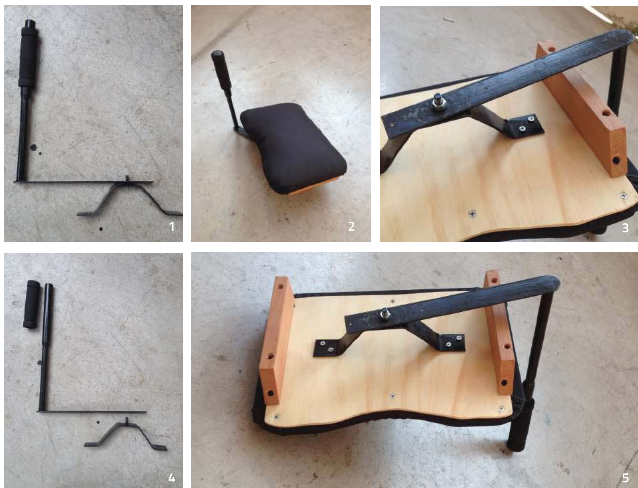
Fig1,4.- La manilla del timón y su despiece
