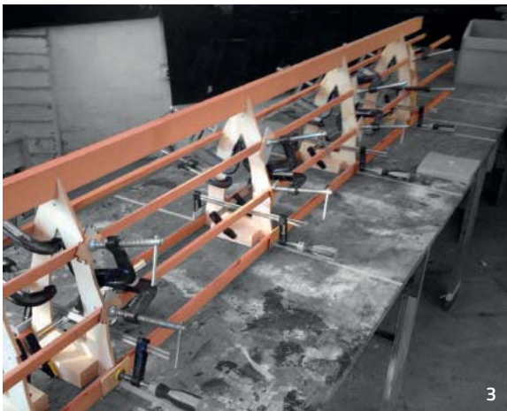
Fig1.- Ubicación de las cuadernas sobre la superficie Fig2.- Nivelación de las cuadernas, usando un hilo como guía Fig3, Fig4.- Ubicado y pegado de la primera parte de la quilla en conjunto con los listones laterales
