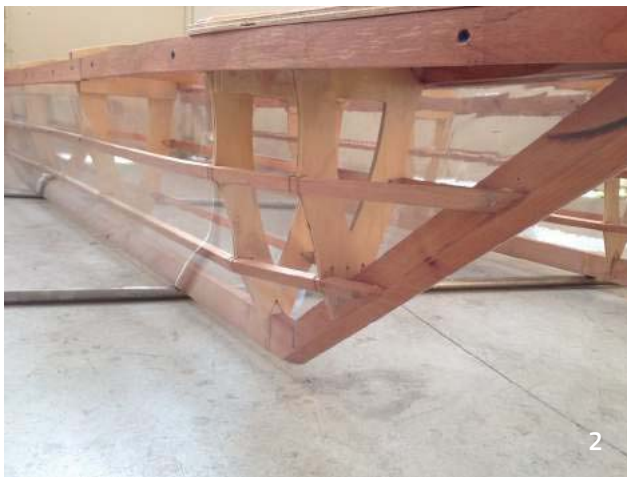
Fig1.- Las estructuras del casco listas y impregnadas con Cerestain Fig2.- Detalle de la proa, membrana transparente de plástico PVC Fig3.- El plástico pvc que envuelve a las quillas de forma sutil y leve Fig2.- Detalle del borde construido envolviendo y sosteniendo al plástico
