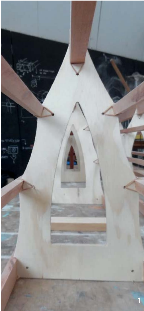
Fig1.- Detalle de la costura de una cuaderna central con los listones.
