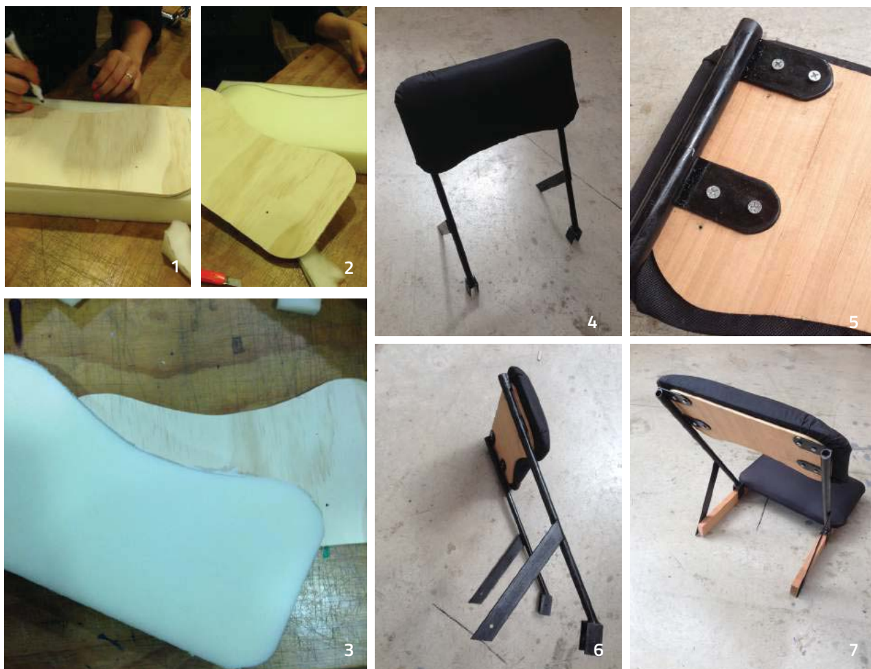
Fig1,2,3.- Construcción de la parte acolchado del respaldo
