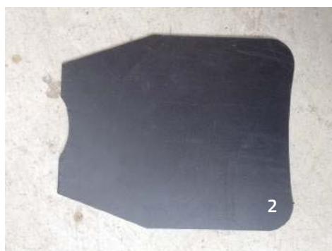
Fig1.- Impresión de la pieza en la impresora 3D Fig2.- Parte semiflexible de plástico PVC 3mm Fig3.- Mitad del perfil de la aleta en impresión 3D
