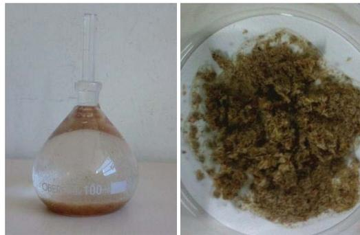
Figura 3.2: A la izquierda imágenes del picnometro y a la derecha musgo despues de la medición de humedad
