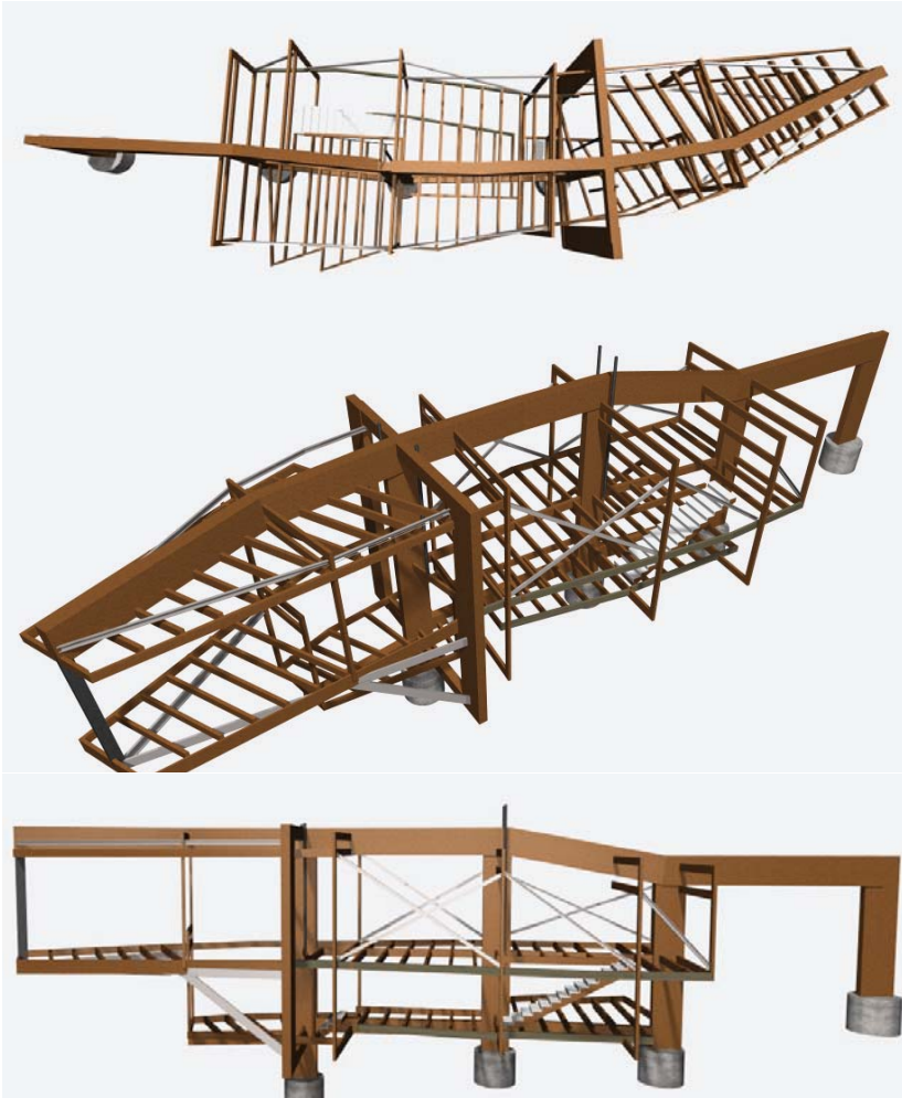
Vistas modelos 3D del estudio de la estructura: Pilares “mastiles”, sobre zapatas de hormigón. Sobre ellos, una viga madre horizontal. Que sostiene toda la nave central. En gris tensores de acero.
