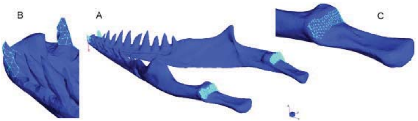
Modelo 3D de mandíbula inferior de un “ varanus komodeinsis ”. Se aprecia el engrosamiento de la sección en el punto de mayor presión o “momento flector”. Este grosor da forma a un molar.
