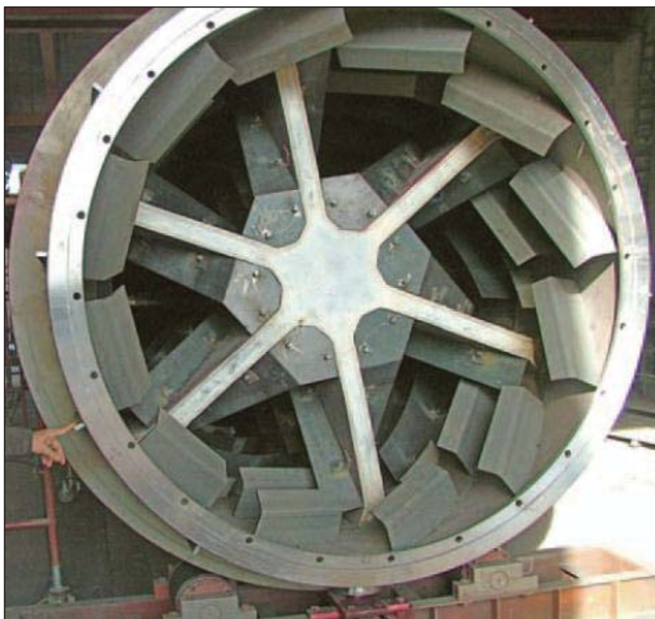
Figura 8.16 – Enfriador Seccional Lado Entrada.
