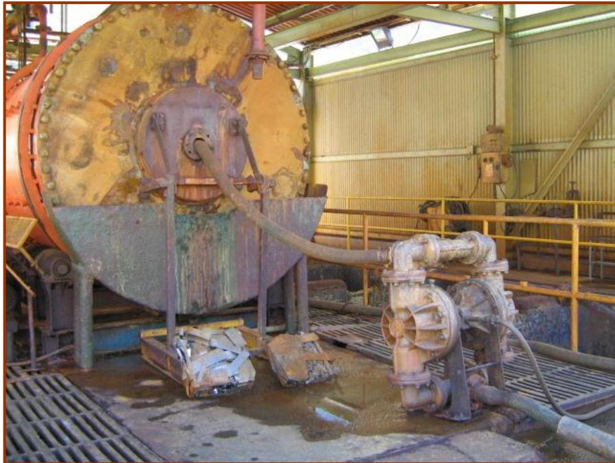
**Figura 2 – 4:** Imagen del tambor rotatorio de cementación de cobre.
