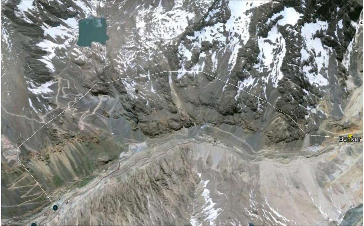
**Figura C – 23:** Túnel de desvío del Río Blanco (línea blanca). El último trazo de la izquierda corresponde al descenso del curso del río (imagen obtenida desde Google Earth y Digramada según información TADA I)<sup>7</sup>
