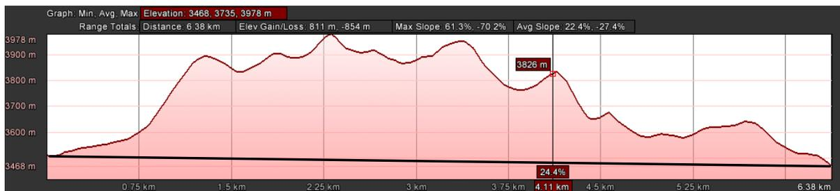
**Figura C – 24:** Perfil de elevación (la línea negra muestra el camino que seguirán las líneas de conducción en descenso)
