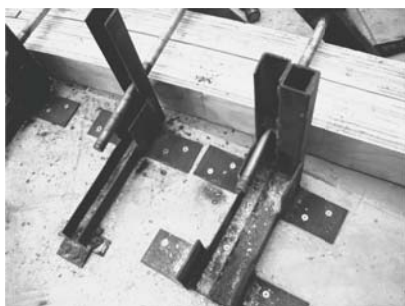
prensa: 17 prensas de fierro que dan la curvatura y reciben en su conjunto a 2 cuadernas bajo y sobre los pernos.
