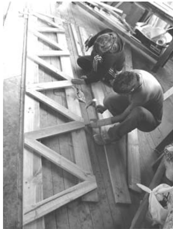
construcción de las seis vigas warren en el taller de los diseños
