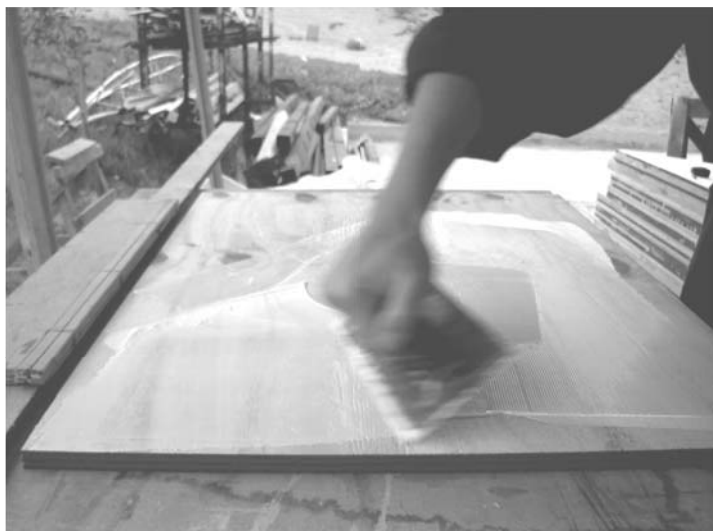
encolado: llana dentada para distribuir uniformemente la cola sobre la plancha
