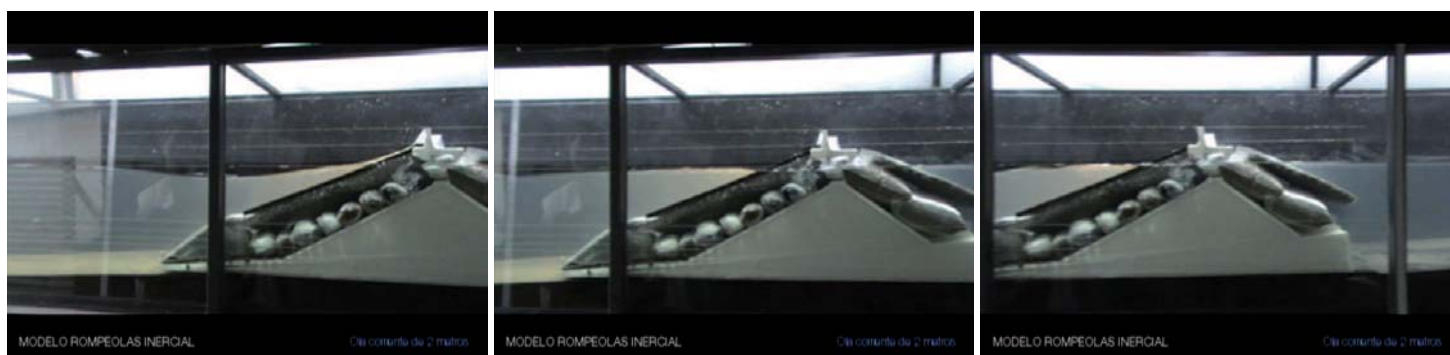
Figura 253. Secuencia fotográfica prueba modelo rompeolas inercial para una ola corriente de dos metros
