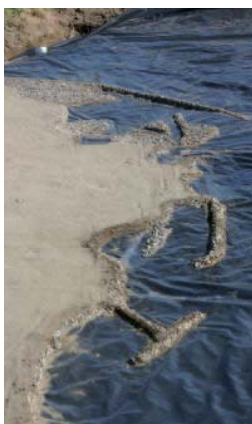
Figura 234. Modelamiento de la costa y sus protecciones (sobre el nivel del mar)
