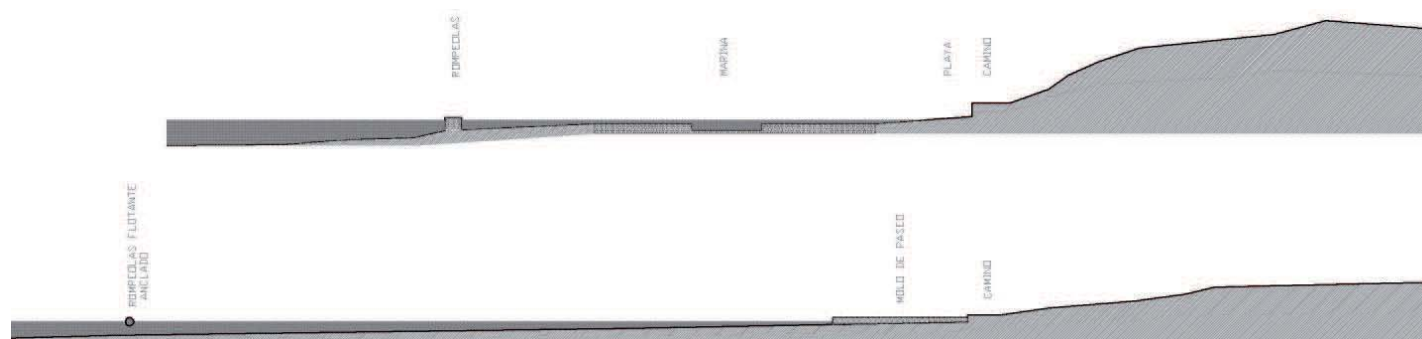
Figura 237. Perfiles conceptuales configuración de rompeolas y dársena
