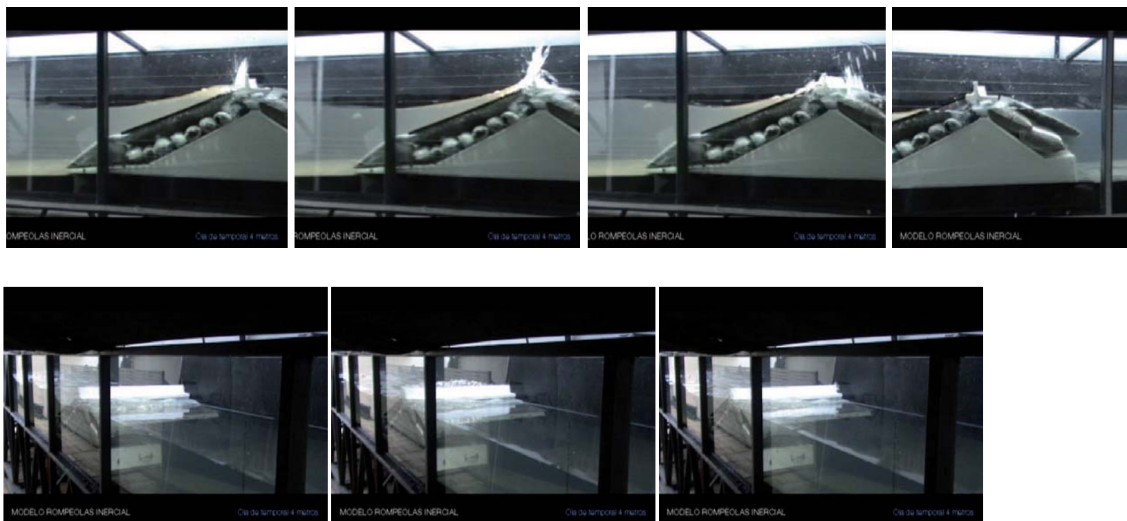
Figura 256. Secuencia fotográfica prueba modelo rompeolas inercial para una ola severa de temporal de 4m. Vista sobre nivel del mar
