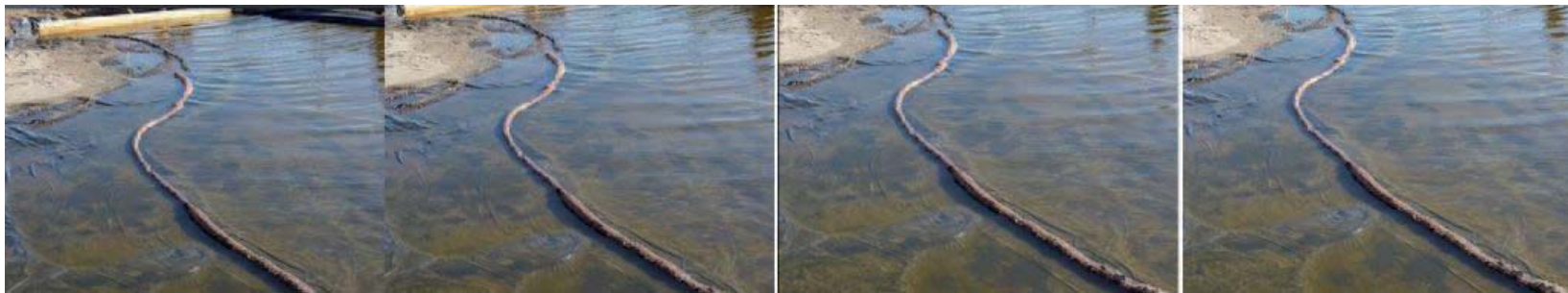
Figura 239. Prueba rompeolas bahía de Concón y rompeolas lilenes para oleaje sur-este. disposición 2. Registro fotográfico del autor
