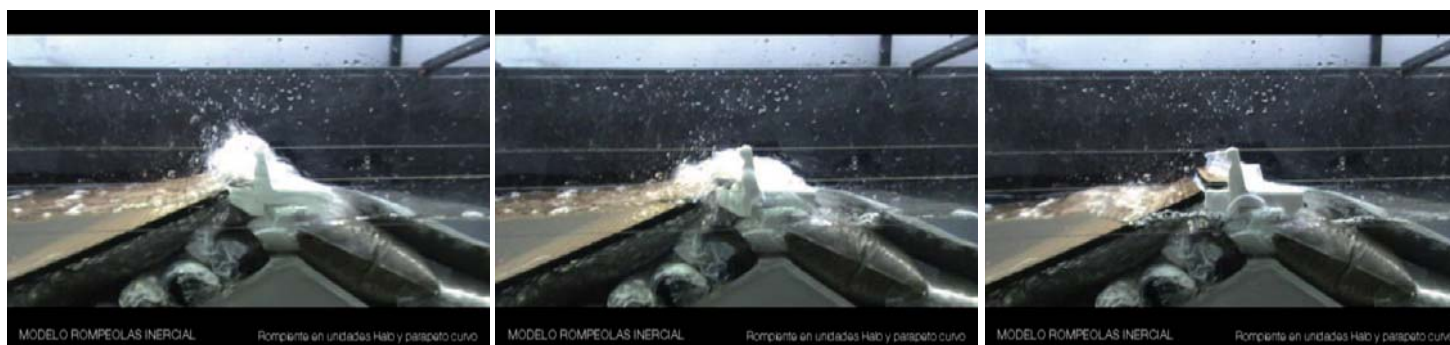
Figura 252. Secuencia fotográfica prueba modelo rompeolas inercial con coraza de halos y parapeto de hormigón. Se observa la efectividad de la geometría del rompeolas con su curva exterior, la cual logra retornar la ola disipando su energía, a su vez se observa la eficiencia de la capa coraza conformada por las unidades halo.
