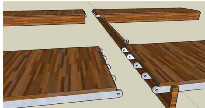
Fig. 189 y 190. Modelo Homero Latorre. Pasarelas transversales al estero, diseñadas como unidades discretas auto soportantes y vinculadas mediante unión articulada. Materialidad de acero galvanizado y maderas laminadas.
