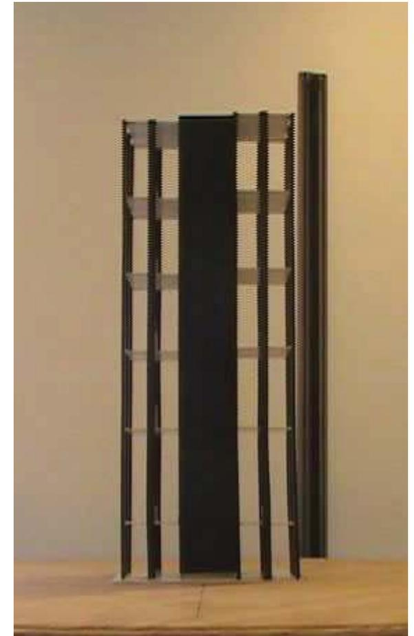
Fig. 238. El rango de oscilación aumenta. Se observa que no es solo por el aumento de masa, sino por el aumento de las torciones aportadas por las 2 estructuras laterales. La estructura se mantiene mas rígida, pero gira más sobre su propio eje, aumentando el rango.
