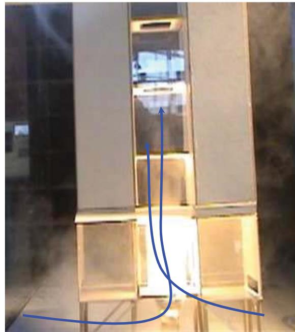
Fig. 213. Modelo H.L. La velocidad de ascenso del aire aumenta con el aumento del viento predominante.
