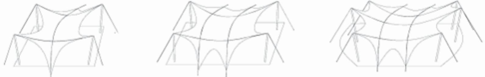
Fig. 127. Esquemas de diferentes configuraciones básicas para conformar una tenso – estructura mediante la doble curvatura. Fig. 125, 126 y 127, extraídas del libro Temas de estructuras especiales, Perles, P.
