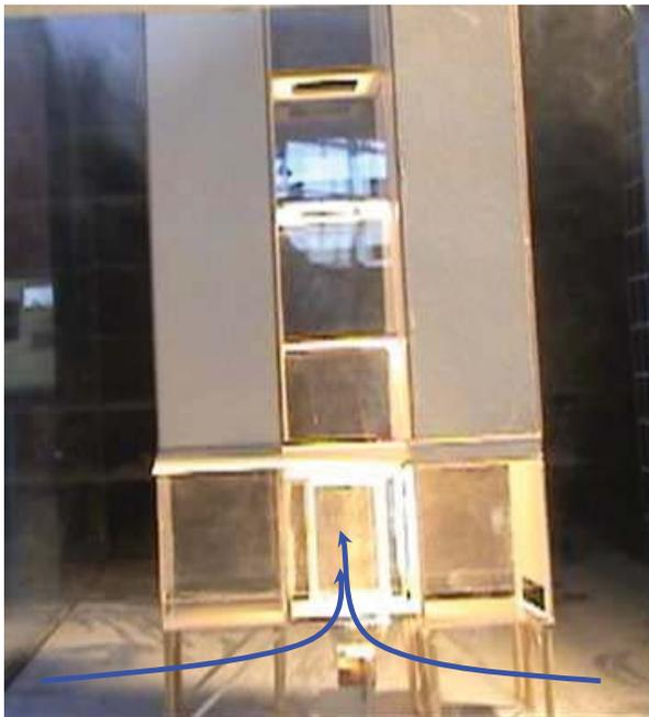
Fig. 212. Modelo H.L. Inicio del proceso de succión por parte del venturi superior que acelera el aire.
