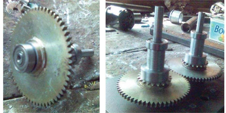
Fig. 173 y 174. Fotos H.L. Engranajes de transmisión , movimiento excéntrico de masas.
