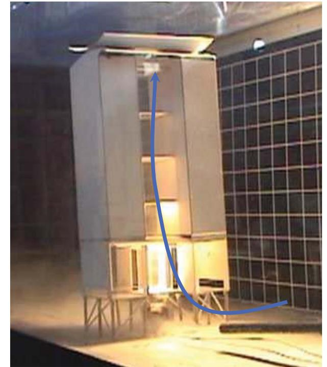
Fig. 215, 216 y 217. Modelo H.L. En la parte baja se instala un foco cuya finalidad es subir la temperatura del aire, puesto que en la realidad el asoleamiento y la habitabilidad de la zona baja (núcleo ciudadano), aportarán temperatura, lo que ya provocará el ascenso natural del aire. Para mayor y mejor control se diseña el dispositivo de aceleración y se proyecta un sistema de obturación para su manejo.
