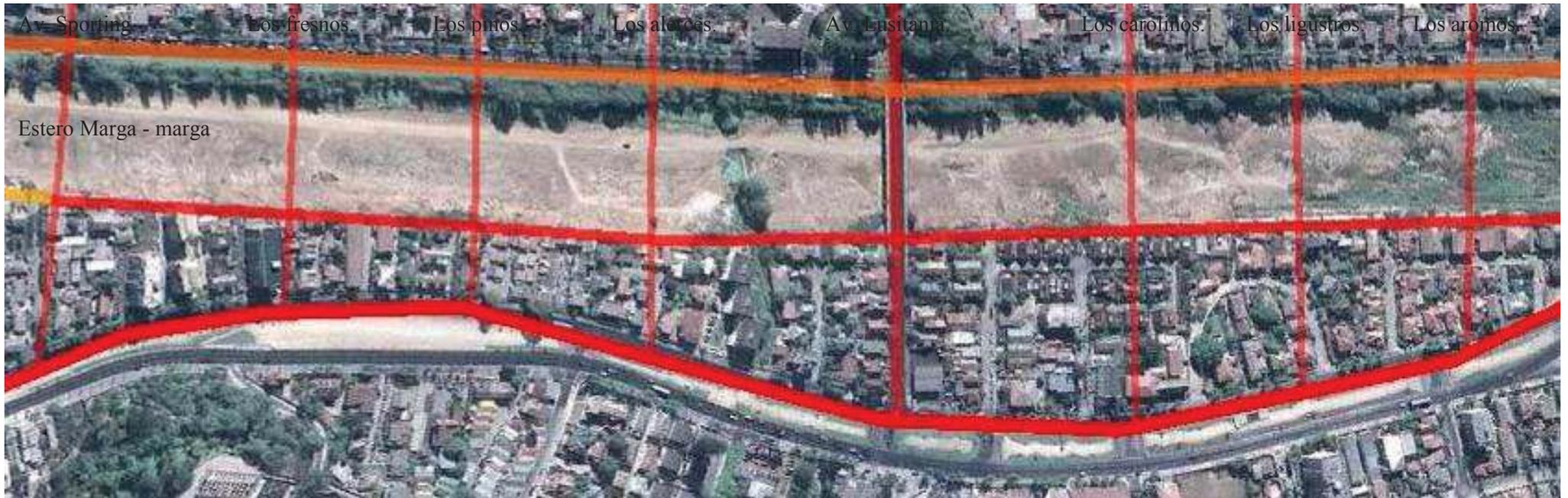
Fig. 205. G.Earth. Nuevo trazado. A la existencia del puente vehicular en av. Lusitania, se le suman 6 puentes atirantados peatonales y ciclo - vías y un nuevo puente vehicular en Av. Sporting hasta Marina.
