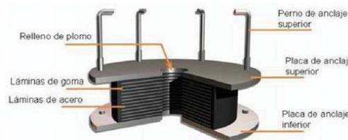
Fig. 150. Amortiguador de base, caucho, plomo y acero.
