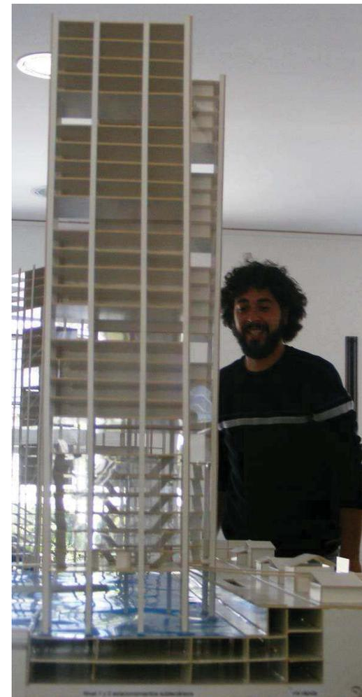
Fig. 264. Maq. esc. 1:200, vista lateral de un edificio pórtico, se puede ver la constitución de la zapata hueca de fundación, con las áreas sub – terráneas, para estacionamientos y circulaciones vehiculares.
