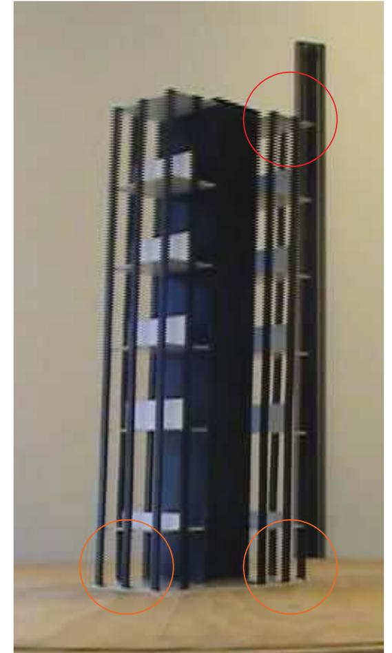
Fig. 240 y 242. Para la construcción de este modelo, se utilizó goma negra, liza, de 4mm de espesor. Todos los elementos estructurales del edificio son construidos del mismo espesor, pues se propone una estructura completamente de acero (pilares, vigas y diagonales arriostrantes).
