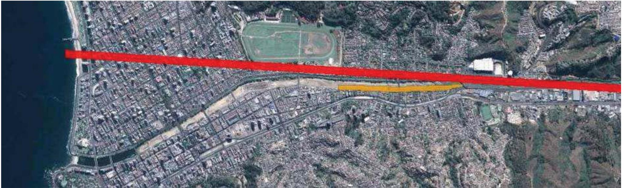
Fig. 130. Vista aérea google earth. Se indica en rojo el trazado de la falla sísmica del Marga – marga, que atraviesa la zona urbana de Viña del mar. En amarillo el terreno destinado al proyecto propuesto
