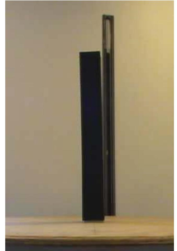
Fig. 232. Se mide una oscilación de 1,5cm respecto del eje vertical, el modelo se aprecia inestable.
