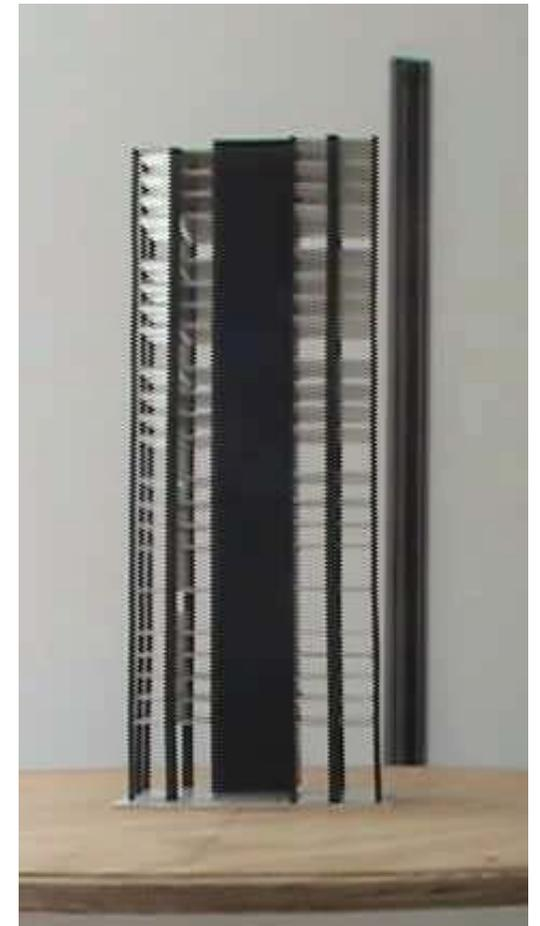
Fig. 246 y 248. En este modelo, los elementos estructurales horizontales, son construidos en cartón 2mm de espesor y representan a losas de hormigón armado pre – tensadas, según la propuesta estructural. Al sumarle todas las losas existentes, cada uno de los cuerpos laterales logra mayor rigidez, absorbiendo parte de la oscilación y la torsión, siendo solidario con el núcleo central arriostrado.
