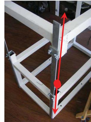
Fig. 178. Pletinas galvanizadas posibilitan el desplazamiento vertical de la superficie superior, aumentando o disminuyendo la capacidad de pendular de la mesa.
