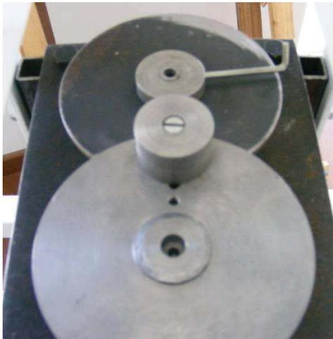
Fig. 176. Platos soportes de masas para generación de movimiento excéntrico.
