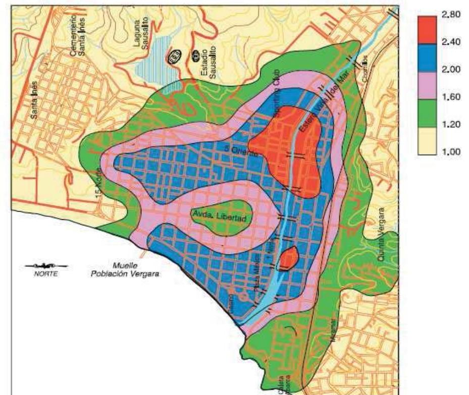
Fig. 129. Plano distribución de aceleraciones sísmicas en torno a la desembocadura del estero Marga – marga en Viña del mar. Zona de acumulación ancestral de sedimentos.
