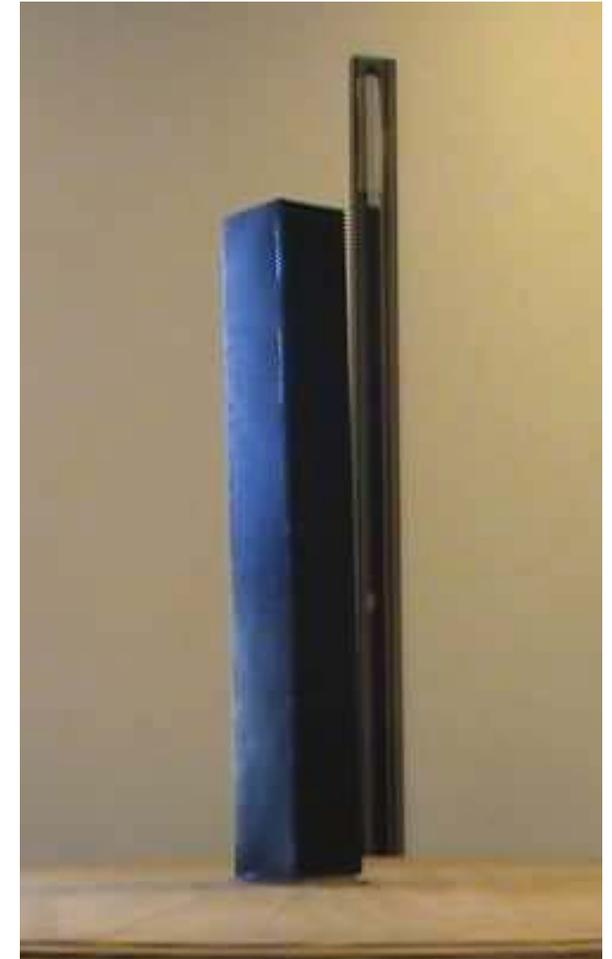
Fig. 234 y 236. El núcleo central de arriostamiento, como ya se ha señalado, es un volumen de aire entre los dos cuerpos habitables de los edificios póricos. Para las pruebas en la mesa generadora de oscilaciones, el núcleo aparece negro, pues estructuralmente es un elemento completamente arriostado. Como un muro cada una de sus 4 caras. Ver fotos de maqueta de arquitectura y planos.
