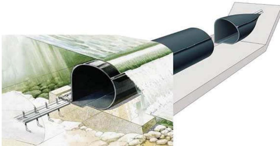
Fig. 121. Perspectiva de montaje y funcionamiento de una represa inflable.
