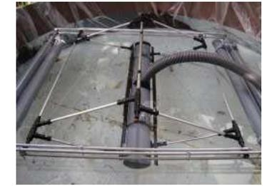
Imagen 229. Pruebas de despliegue en piscina, el mecanismo alcanza un grado de desarrollo y justeza. La serie de pruebas resulta exitosa, comprobando la relación de pesos necesaria para el despliegue.
