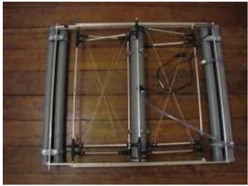
Imagen 226. Modelo 7, rigidización de los planos de elevación e inmersión.
