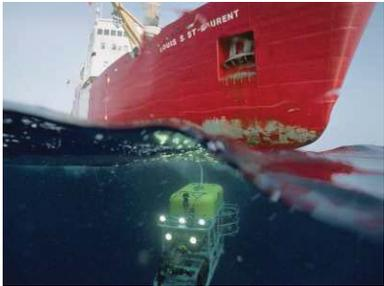
Imagen 147. ROV prospectando el casco de una embarcación.
