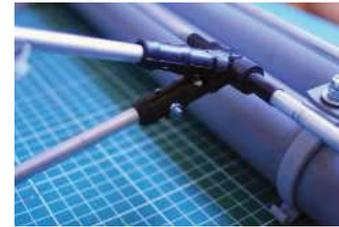
Imagen 240. Diseño de una pieza de transmisión directa de la componente entre el pontón central y el espacio habitable.
