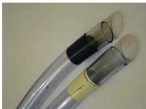
Imagen 206. Mangueras de llenado y vaciado del pontón central.
