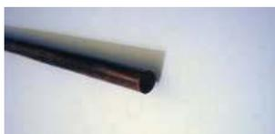
Imagen 208. Vara de cobre para otorgar pesos al modelo.
