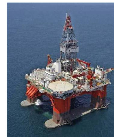
Imagen 150. Vista aérea de una plataforma semi-sumergible con sus pontones emergidos.
