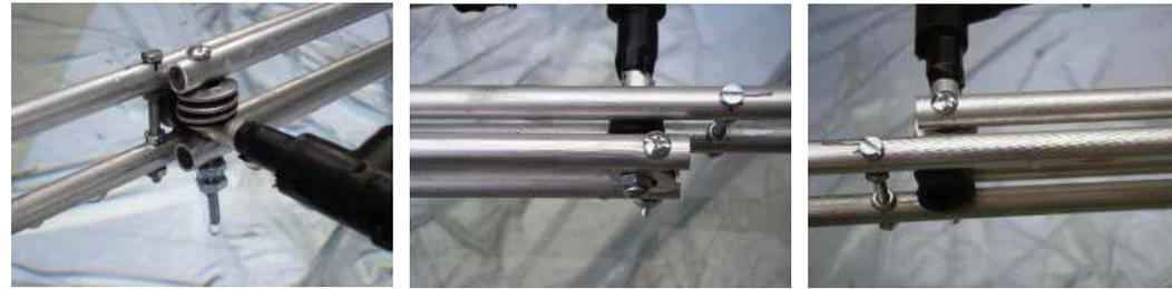
Imagen 217. Modelo 6, detalle de la construcción de topes en el recorrido de las correderas y el calce de la rueda en los perfiles guías.
