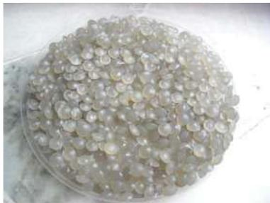
Imagen 186. Formato base del HDPE en forma de pellets incoloros.
