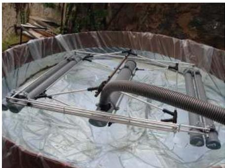
Imagen 222. Modelo dispuesto en la piscina de pruebas en su configuración plegado.
