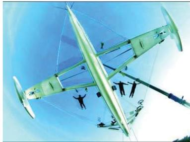
Imagen 174. El Hydroptère es un velero hidrofoil cuyo diseño de hidropiano multicasco le permite alcanzar grandes velocidades. Rompió el récord mundial mantenimiento de una velocidad de 52,86 nudos (97,90 kmh; 60.83 mph) durante 500m con 30 nudos de viento.
