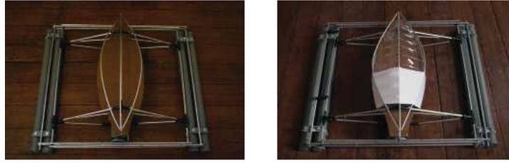
Imagen 266. Instalación de curvas en la estructura y construcción de la envolvente.
