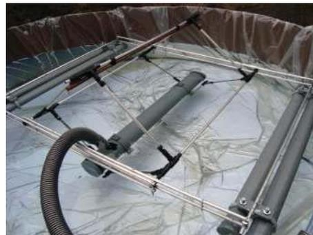
Imagen 224. Aleatoriamente se logra realizar inmersiones estables del pontón central con un correcto despliegue de la estructura.
