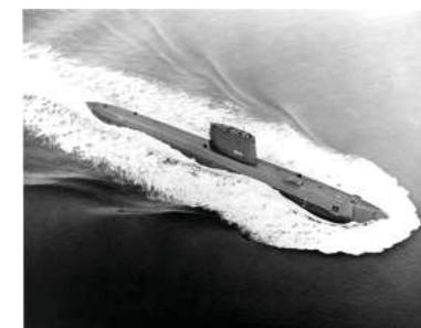
Imagen 144. Los submarinos modernos suelen tener forma ahusada. Este diseño, usado ya en los submarinos más primitivos, se inspiró en el cuerpo de las ballenas y reduce significativamente el arrastre hidrodinámico sobre el submarino bajo el agua, pero empeora su comportamiento frente al oleaje e incrementa el arrastre en superficie.
