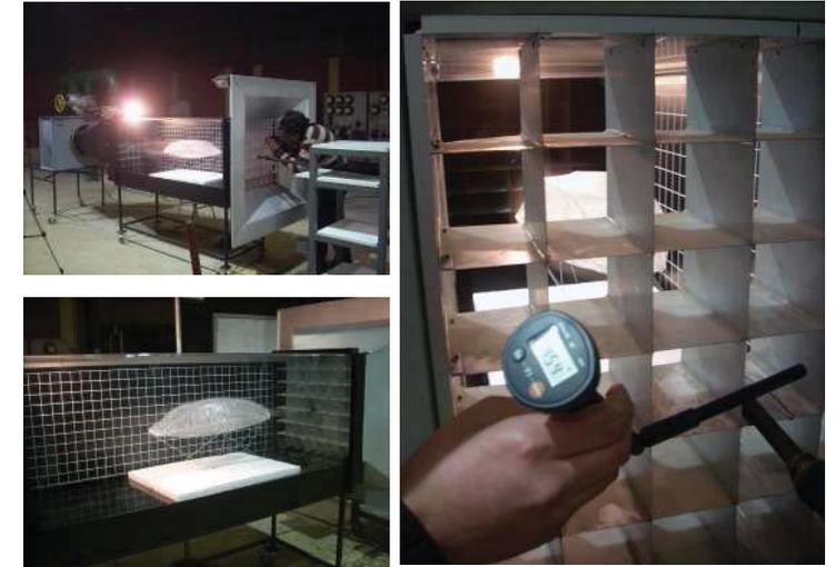
Imagen 295. Vista de la prueba aerodinámica con el modelo flotando en la sobre una superficie móvil de aislapol. Imagen. Medición de la velocidad del flujo con un anemómetro.
