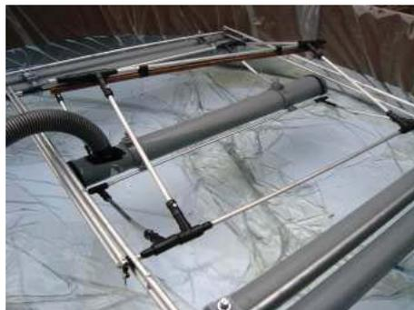
Imagen 223. Inicio de llenado del pontón central muestra irregularidades en la inmersión del mismo y en la elevación del peso superior.
