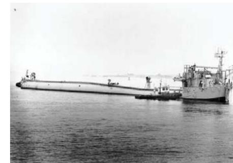
Imagen 154. Flip en su posición horizontal, en la cual es remolcado a los lugares donde se realizan las investigaciones.
