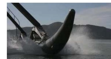
Imagen 179. Detalle del pontón flexible que se adapta a la superficie del mar y amortiguadores de unión con los brazos-arco que estructuran y unen los pontones.
