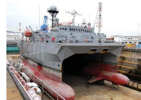
Imagen 161. El USNS Impeccable en dique seco, se puede observar su sistema de casco SAWTH.
