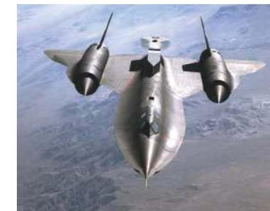
Imagen 181. Lockheed SR-71 construcción de superficies aerodinámicas en titanio.
