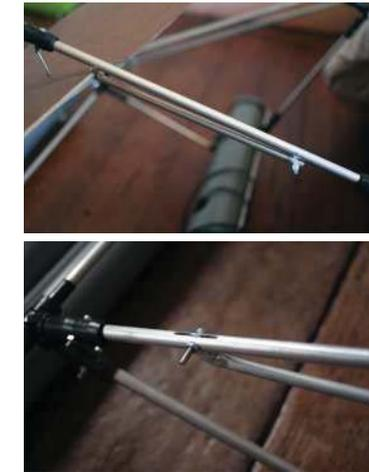
Imagen 237. Propuesta de pieza perforada con unión especialmente diseñada para otorgar rigidez.
