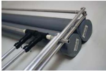
Imagen 211. Modelo 5, detalle de pieza balancín adaptada en el eje móvil de corredera.
