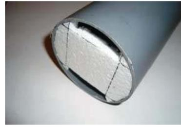
Imagen 228. Pruebas de mamparos divisores interiores al pontón central para el control de la distribución del lastre interior.
