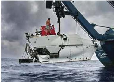
Imagen 146. Sumergible Alvin siendo depositado en el agua.
