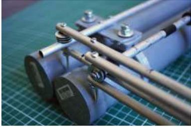
Imagen 277. Detalle de unión de las piezas correderas y los pontones laterales.
