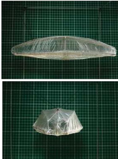
Imagen 262. Primer modelo de traspaso de envoltente de doble curvatura de la película de jabón a plástico tensado.
