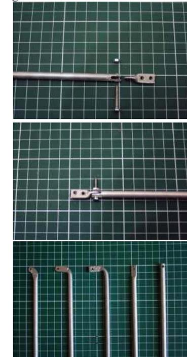
Imagen 238. Proceso de construcción del extremo de la pieza de unión.
