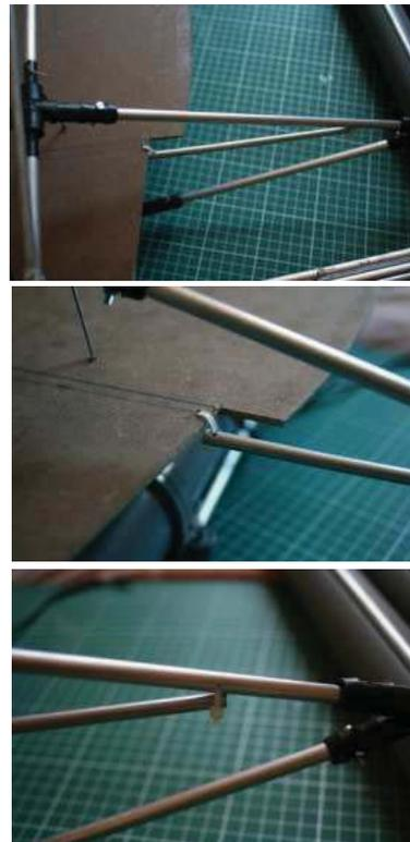
Imagen 236. Unión realizada con perfiles perforados y aprieta cables, resulta con un mínimo juego que debe corregirse.
