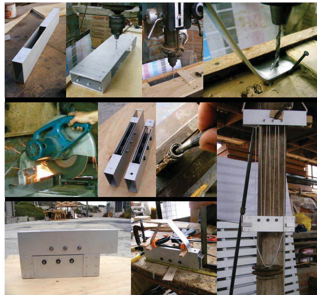
Figura 112. Secuencia de imágenes del proceso constructivo del sistema de arrastre.
