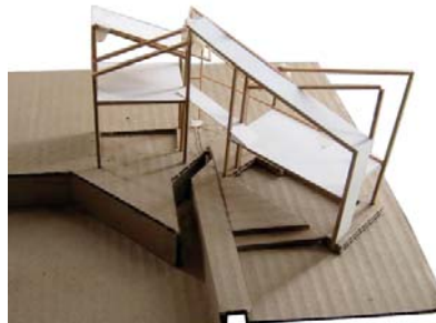
2 Extensión en Giro (Viviana Camps) Giro diagonal que otorga ancho y amplitud que construye la permanencia. Aparece una dimensión de salón como área común que reúne. El quiebre sectoriza el programa dándole momentos al traspaso del total. (Maqueta: Camilo Corces, 3° Arq.)
