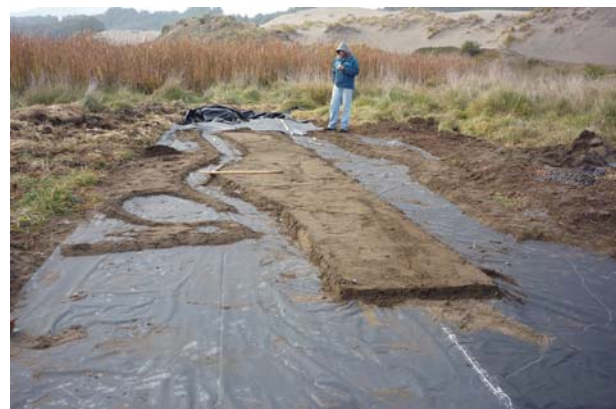
Segunda configuración portuaria. En la primera foto se puede ver que se mantuvieron los canales y la poza del humedal, pero se utiliza solo un molo curvo al norte y molos semisumergidos al sur. .Fotos de registro.
