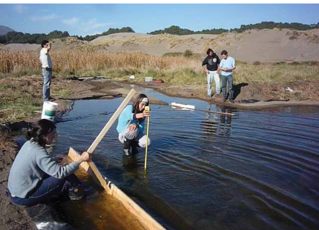
Momento en que se realiza el oleaje N con una paleta de madera.
