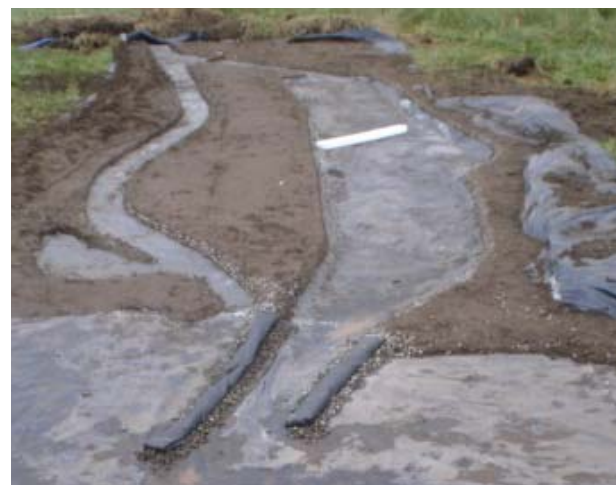
Primera configuración portuaria, llenado del modelo A la derecha de la fotografía se ve el canal portuario al sur. El brazo norte corresponde al actual río aconcagua. que termina en la poza humedal. hacia abajo la entrada de mar y los molos rompeolas.
