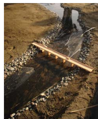
Sobre el polietileno se comienza a modelar con arena, los bordes se contienen con piedras sin perder la proporción con la realidad, además se agregan elementos como puentes que ayudan a mantener la escala en los videos. Fotos de registro de faenas.
