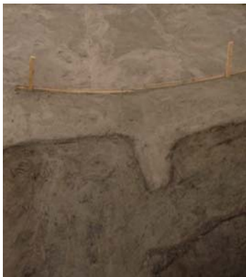
Trazado de las batimetrías en la arena, con llanas se logra el acabado liso para no perturbar el oleaje. Fotos de registro de faenas.
