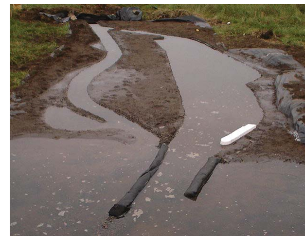
Primera configuración portuaria, llenado del modelo A la derecha de la fotografía se ve el canal portuario al sur. El brazo norte corresponde al actual río aconcagua. que termina en la poza humedal. hacia abajo la entrada de mar y los molos rompeolas.
