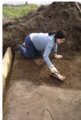
Trazado de las batimetrías en la arena, con llanas se logra el acabado liso para no perturbar el oleaje. Fotos de registro de faenas.
