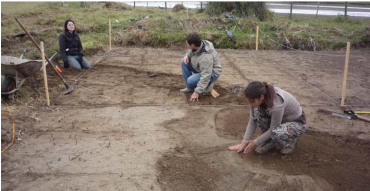
Trazado de las batimetrías en la arena, con llanas se logra el acabado liso para no perturbar el oleaje. Fotos de registro de faenas.
