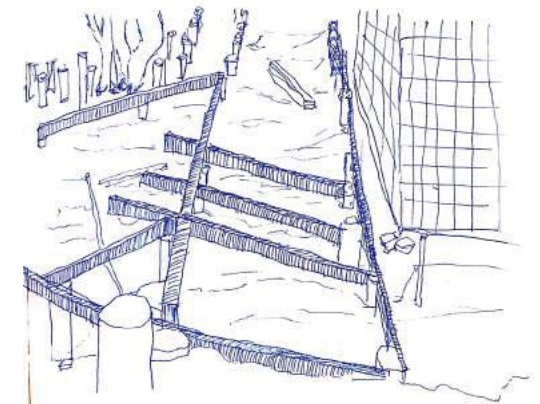
Croquis del entablado obra, construcción del suelo
