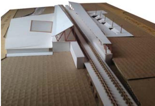
Vista de la maqueta que muestra las pendientes de las cubiertas.
