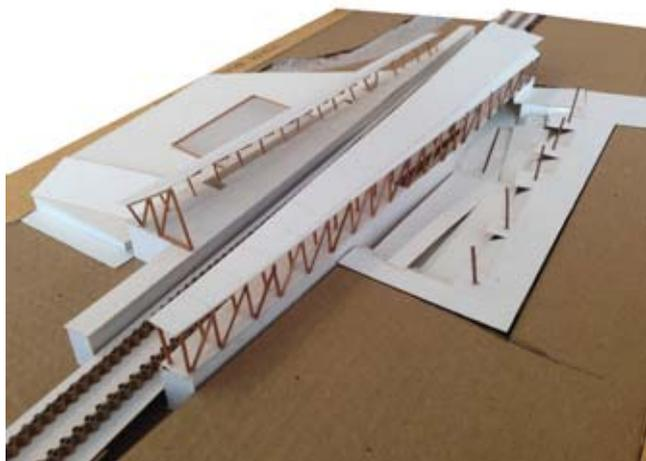
Vista que muestra el sistema de pilares que conforma el cerramiento de la estación.
