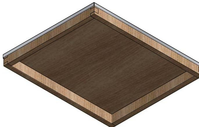
La tapa se compone por un tablero base atornillado a un marco compuesto por listones de 2x1 ", pueden ser un poco mas anchos. Arriba de la base de madera se coloca plumavit de 5 o 10 mm, que se utiliza como aislante para ayudar a mantener la temperatura de la colmena. Y finalmente se coloca una placa de zinc o lata para proteger la tapa.
