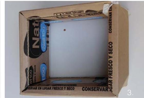
El primer prototipo intenta generar una estructura resistente al peso con el material del cartón. Por lo tanto a través de la experimentación con el cartón, pruebas de pliegues, etc, se llega a la conclusión de que hay que intervenir las esquinas de el “cuadrado”, para que este se estructura bien.
