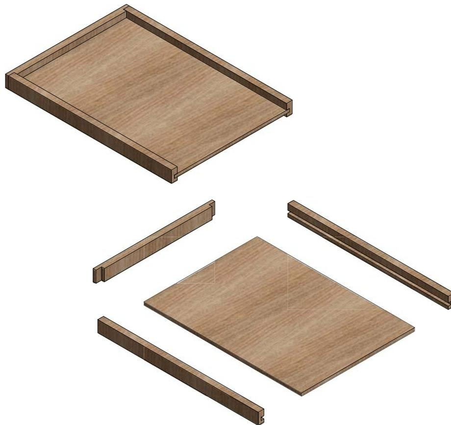
Se compone de un tablero base, de app 2 cm de espesor, que va ensamblado a través de ranuras con dos listones laterales y uno posterior, de medidas 2x1".
