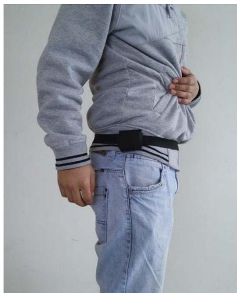
**Figura 10.** Uso correcto del acelerómetro y estuche protector.
