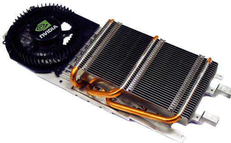
Figura 5.9: Sistema de refrigeración de los modelos GeForce GTX200.
