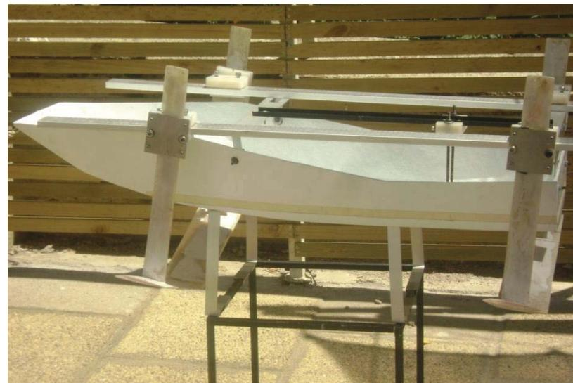
**Fig.87:** Embarcación con perfiles Hidrofoil
