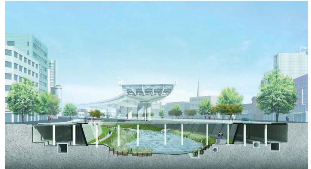
**Fig.32:** Corte que muestra la situación de la vía sobre el cauce del canal.
