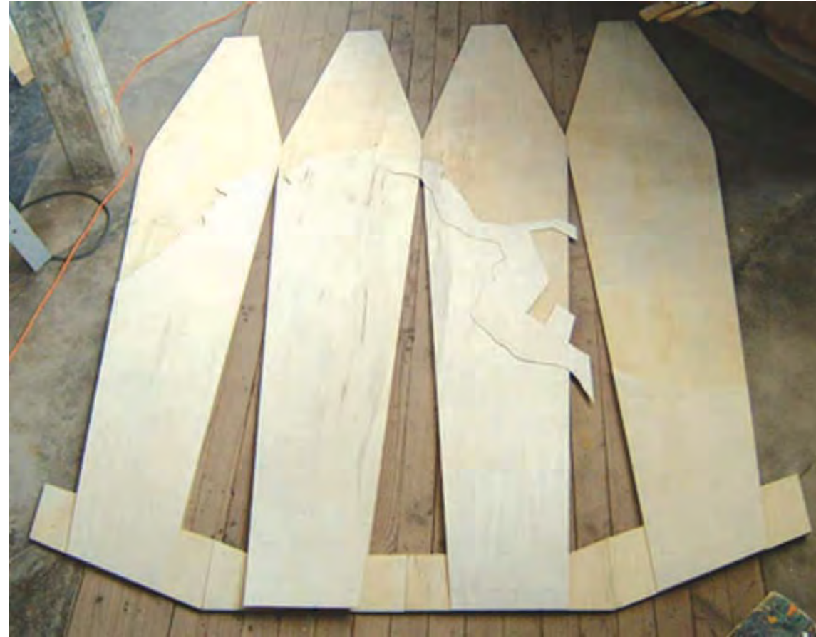
136. Planchas de terciado moldaje de 3,5 y 9 mm. de espesor son el material estructural base del módulo.
