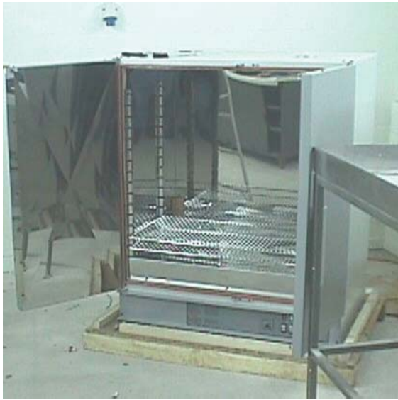
Figura 5.6.: Horno de secado con circulación de aire.
