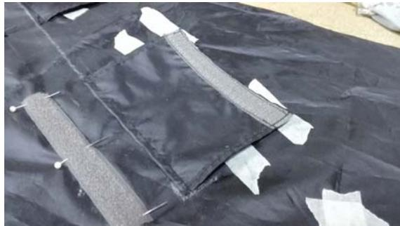
Se decide realizar bolsillos en los cuales fijar la estructura a la tela. Éstos llevan velcro para un montaje y desmontaje más fácil, sin embargo por la forma de la estructura, éstos no logran tensar la tela de punta a punta, por lo que el elemento final a utilizar corresponde a ojettillos en las puntas, permitiendo pasar una amarra plásticas.
