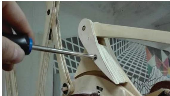
5. Los brazos se fijan colocando la tapa de los ejes fijos
