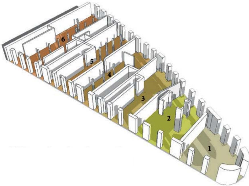
El edificio se subdivide en seis secciones transversales. El nivel de luz naturalvaría e acuerdo a la orientación y al largo de sus muros que son una obstrucción a ésta. La sección 1 es la de mayor iluminación y la 6 tiene menor iluminación.
