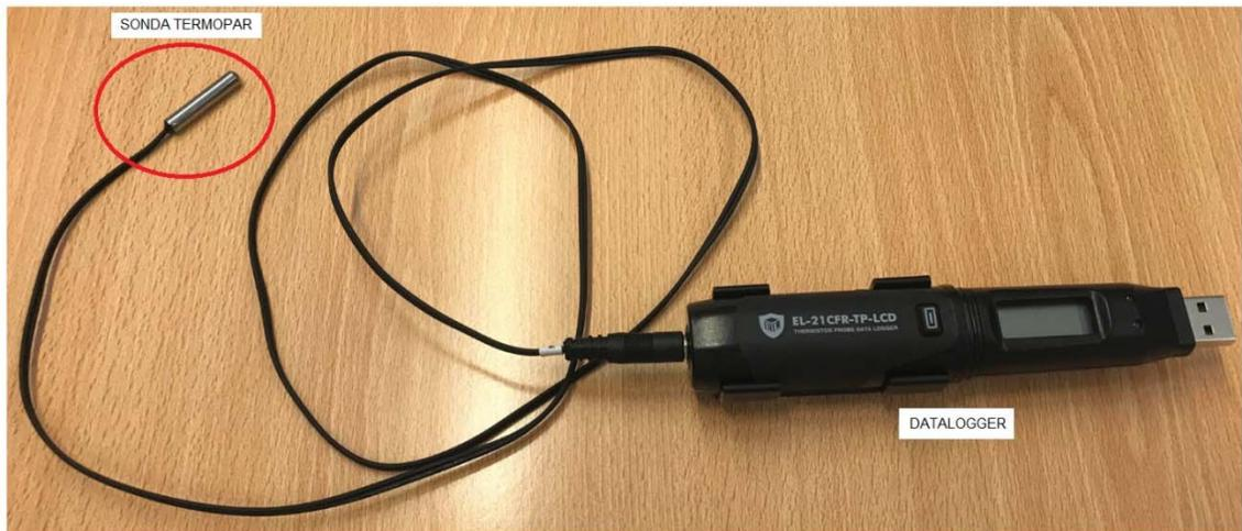
Fig. 4.3: Instrumento de medición termopar datalogger.
