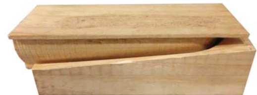
Contraforma Molde B, Material: pino,
