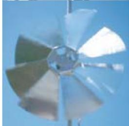
Durante el proceso de creación de un aspa adecuada para el microgenerador eólico de motores reciclados, se piensa en un material liviano, flexible, estructurable y reciclable, o mejor aún reciclado, pasando por cartón, plásticos, basura común como botellas, cuencos plásticos, secciones plásticas laminadas, elementos comunes en los hogares como mangueras, etc. y llegamos de esta manera a las planchas offset utilizadas en imprentas, y que se convierten en un desecho luego de su uso.
