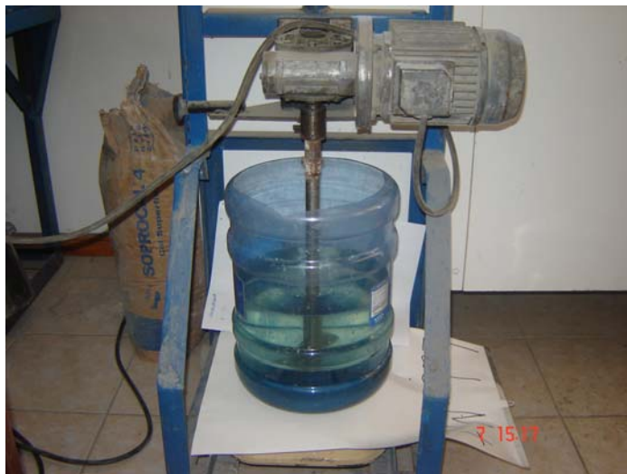
Figura 4.17: Fotografía de la solución pobre, el reactor plástico utilizado y el mecanismo de agitación.
