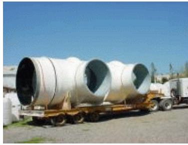
Figura 4.3.- Ducto FRP planta de acido.
