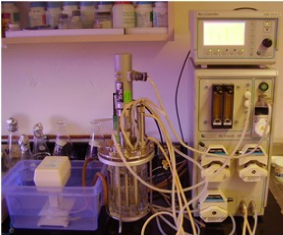
Figura 7.2. Imagen del reactor de mezcla completa de 3 L marca Applikon, Biocontroller ADI 1010, y Bioconsole ADI 1025. Utilizado en experimentos de cultivo en tanque agitado.
