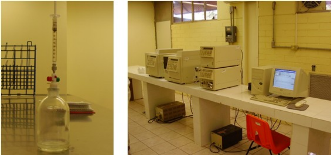
Figura 7.1. Derecha; cromatógrafo de gases usado en la determinación de oxígeno presente en las botellas. Izquierda; Botellas de incubación para análisis de gases.
