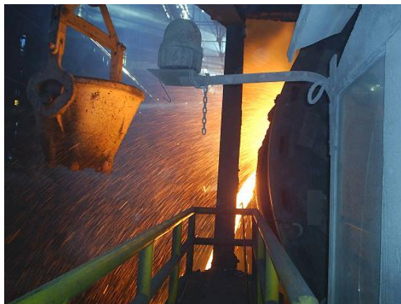
Figura 06: Descarga del CT2, convertidor teniente
