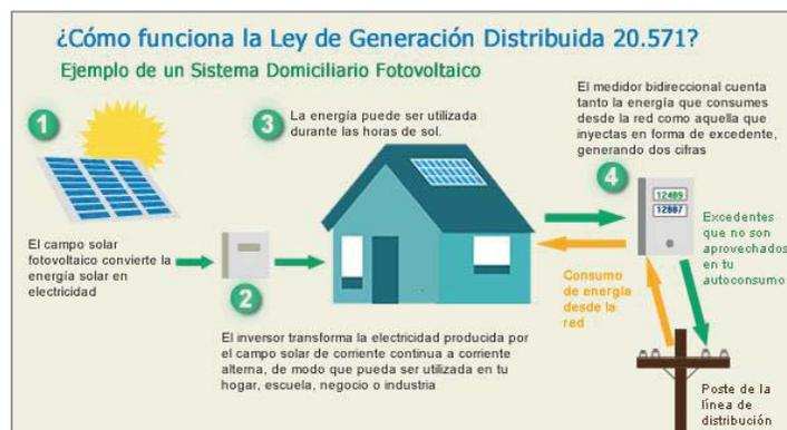
Figura 1-7 Funcionamiento netbilling. (Fuente: [www.sec.cl](http://www.sec.cl))
