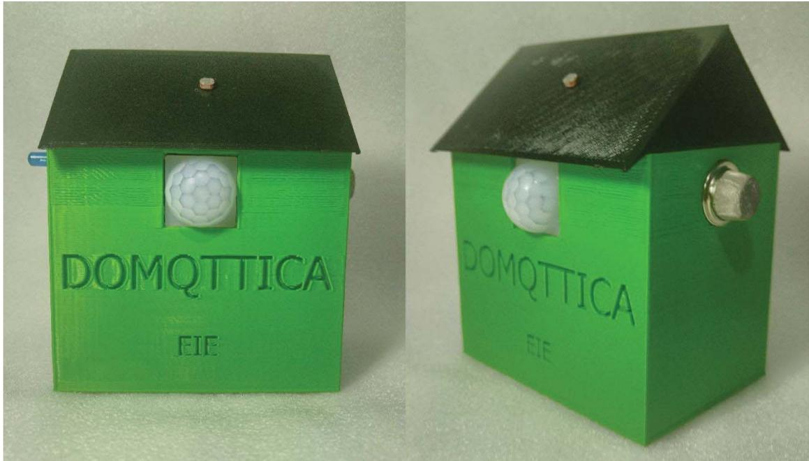
Figura 5-3 Vista frontal y lateral derecha de la carcasa montada con los sensores.
