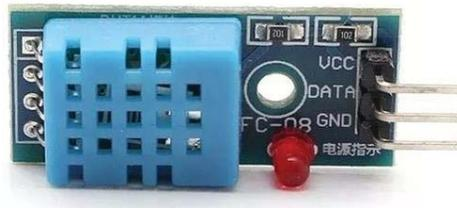
Figura 1-14 Vista de un módulo sensor DHT11 [11].
