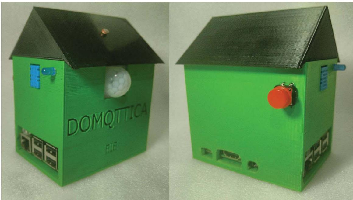
Figura 5-4 Vista lateral izquierda y posterior de la carcasa montada con los sensores.
