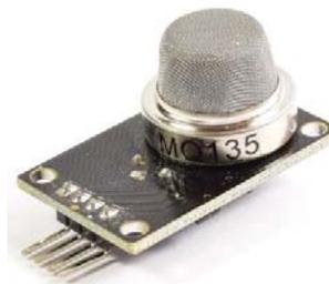
Figura 1-17 Vista de un sensor de calidad de aire MQ135 [14].
