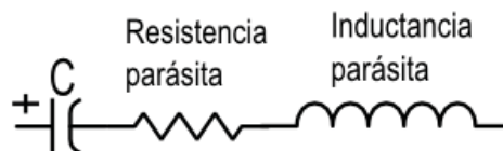
Figura 1-19 Condensador con elementos parásitos
