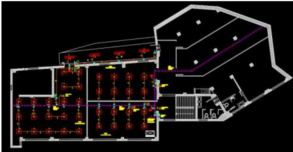
Figura 5-1: Plano de los circuitos presentes en las salas de capacitación 1 y 2.
