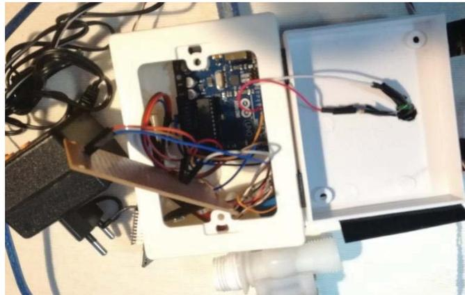
Figura 4-2: Nodo Actuador en proceso de prueba
