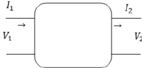
Figura 7-2: Tetrapolo para modelar línea de longitud media
