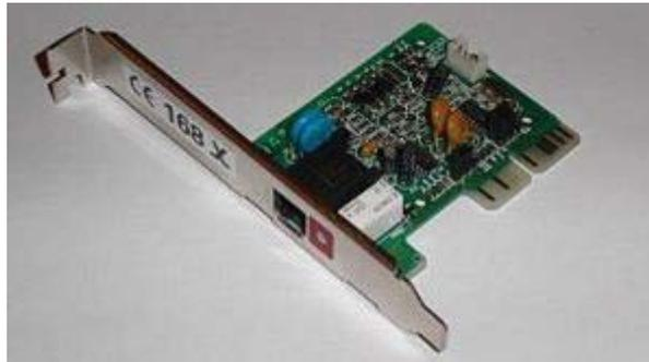
Figura 1-5: Módem AMR con hardware emulado HSP de transmisión telefónica
